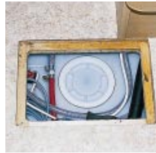
Service Luke im Boden zur Wartung und Reinigung des Frischwassertanks.
