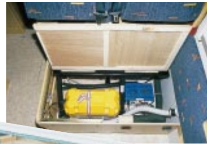
Elektrozentrale leicht zugänglich in der Sitzbank.
