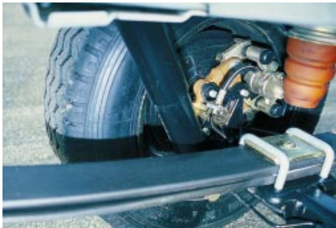
Angepasst: Die Varianten mit dem großen Turbo-Dieselmotor bekommen Scheibenbremsen an der Hinterachse.
