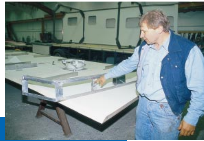
Verstärkt: Hinter der Frontmaske sorgen Verstärkungen aus verschweißten Aluprofilen für Stabilität und Passgenauigkeit.
