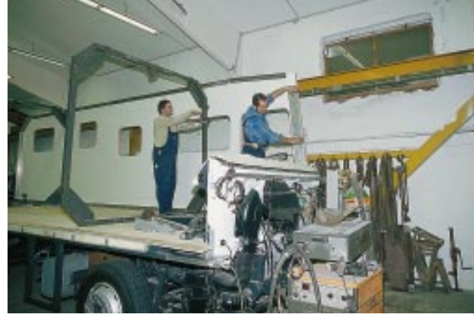
Ausgerichtet: Schablonen helfen bei der exakten Ausrichtung von Boden und Seitenwänden.
