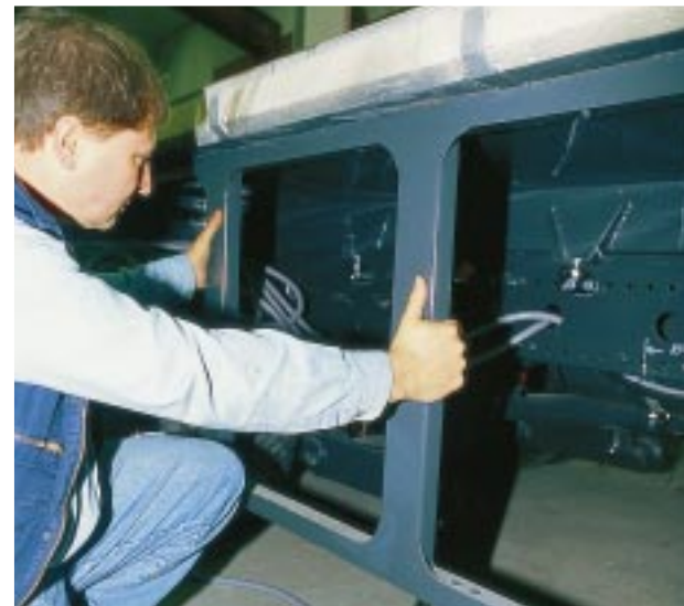
Massiv: Zwischenrahmen und Tragkonstruktion für die Außenstauräume.
