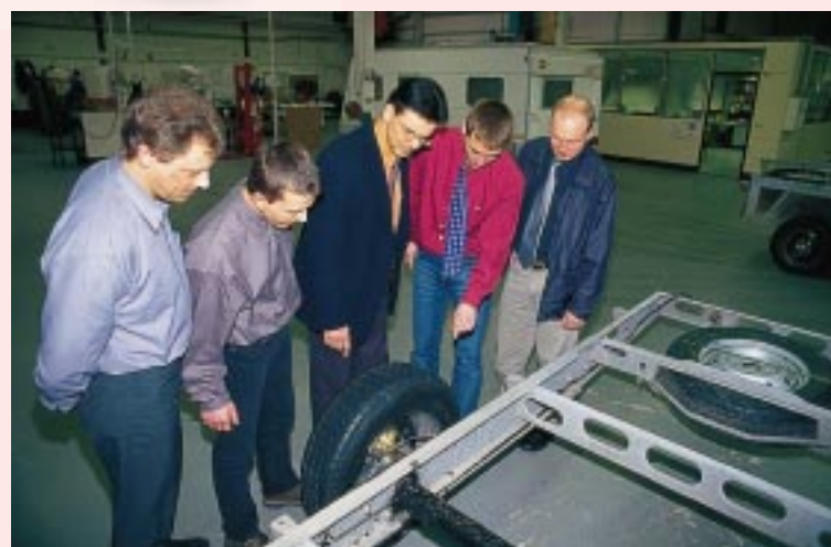
Entwicklung: Wichtigste Änderung an den überarbeiteten Al-Ko-amc-Chassis ist ein neuer Schwinghebel für die Radbremsenaufnahme.
