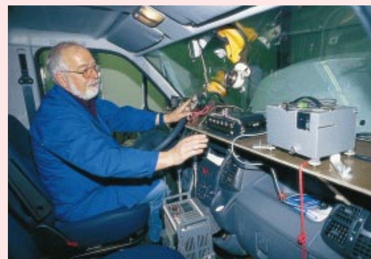
Messwagen: Vollgestopft mit Messgeräten geht der neue Ducato samt Al-Ko-Chassis auf die Prüfstrecke.
