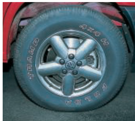
Verwegen: Geländereifen auf 16-Zoll-Felgen und mehr Bodenfreiheit machen den T4 fit für schwieriges Terrain.
