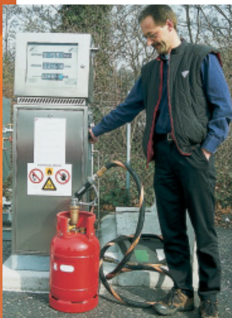
Dank optionaler Verlängerung kann die Tankflasche beim Tanken im Flaschenkasten stehen bleiben.
