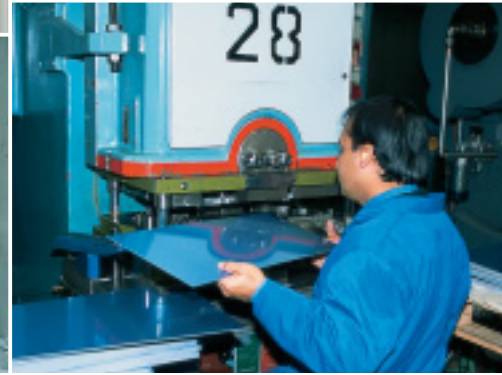
Gepresst: Abgelängte Edelstahlbleche wandern in mehreren Schritten durch die Presse.
