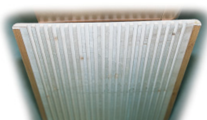
Aufwändig: Rillenfräsungen machen die Möbelplatten leichter, ohne sie in ihrer Stabilität zu schwächen.
