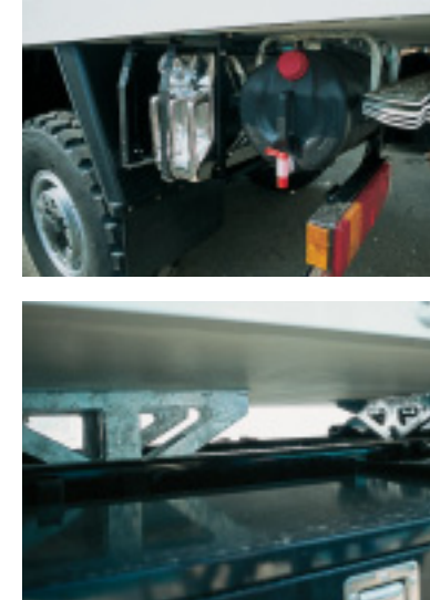
Technisch: Reservekanister, Wasserfässer und Sandbleche hängen am Fahrgestell (oben), hochbewegliche Lagerungen halten Chassis-Verwindungen von der Kabine fern (unten)
