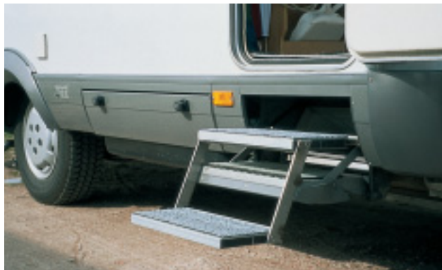
Angenehm: verkürzte Tritthöhe durch Doppeltrittstufe.
