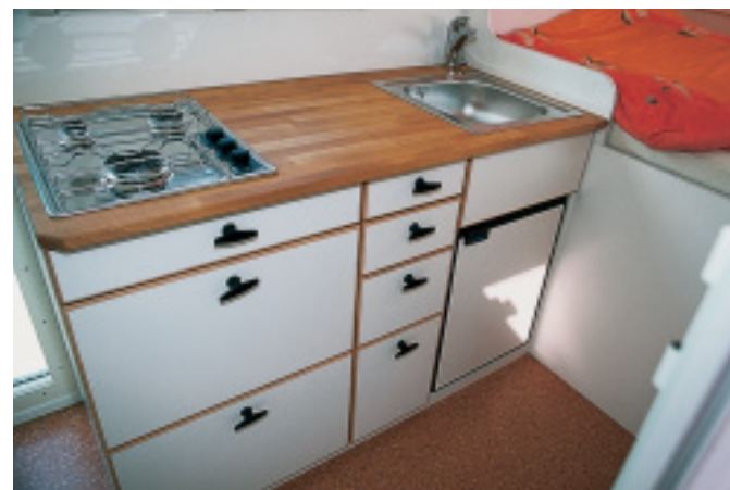
Gestreckt: Küchenblock mit Eno-Gaskocher, Spüle und Kompressor-Kühlschrank.
