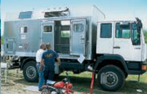
Komplett aus Alu gefertigter Gerippe-Wohnaufbau von Eggers mit Container-Verriegelung.
