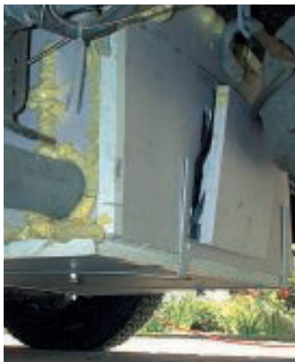
Exakt sitzt die Kiste unter dem Fahrzeugboden und verhindert, dass im Winter das Abwasser einfriert.
