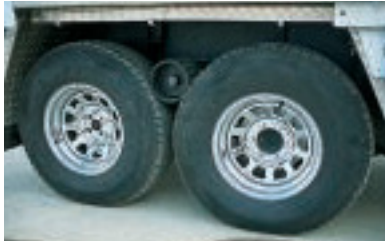
Reutter präsentierte einen umgebauten Pick-up mit über eine Reibrolle angetriebener Nachlauf-Hinterachse.
