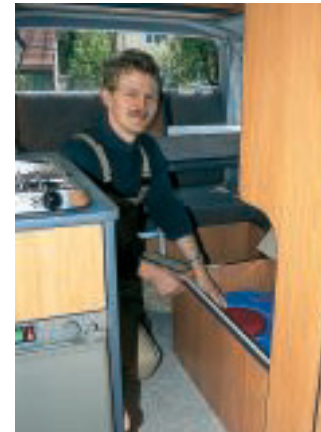
Raum genutzt: In der Sitztruhe steckt der Frischwassertank.
