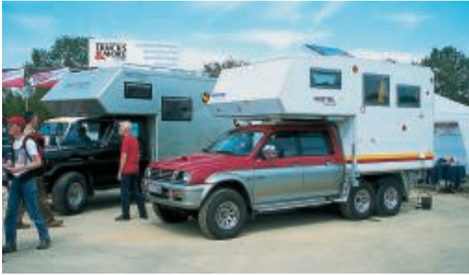
Reutter präsentierte einen umgebauten Pick-up mit über eine Reibrolle angetriebener Nachlauf-Hinterachse.
