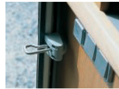
Schließbolzen steht weit in Türausschnitt hinein.
