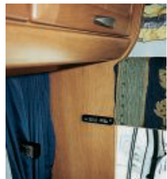
Innerhalb von zwei Stunden eigenhändig montiert: Thermometer, das Innen- und Außentemperatur anzeigt.
