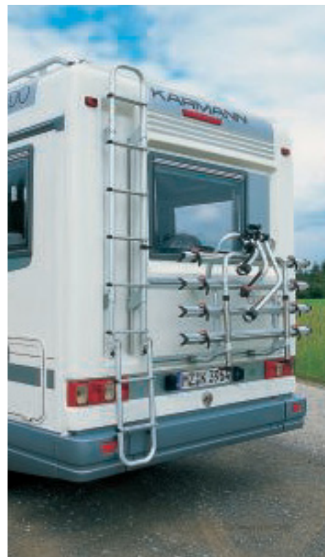
Pfiffig: Die Heckleiter wird in Alu-Schienen geführt, ebenso der Fahrrad-Heckträger.
