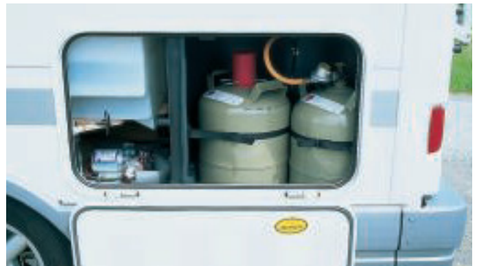
Aufgeräumt: Ablasshahn für Frischwasser, Griff für Abwasserschieber und Gasflaschenkasten befinden sich in einem beheizten Fach.
