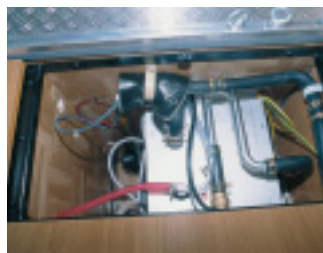
Detailliert: Übersichtliches Kontrollpanel (ganz oben), die Wasserzentrale ist durch eine seitliche Außenstauklappe (Mitte), die Heizung (unten) durch eine Bodenluke im doppelten Boden erreichbar.
