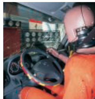
Dummys und Balastsäcke simulieren für den Crashtest Insassen und Beladung.
