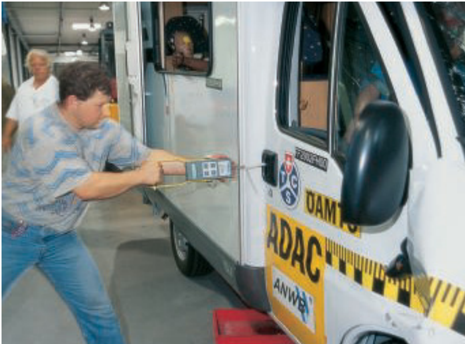
Mit einem speziellen Messgerät lässt sich der Kraftaufwand nachweisen, der beim vergeblichen Versuch, die Beifahrertür von Hand zu öffnen, notwendig ist.
