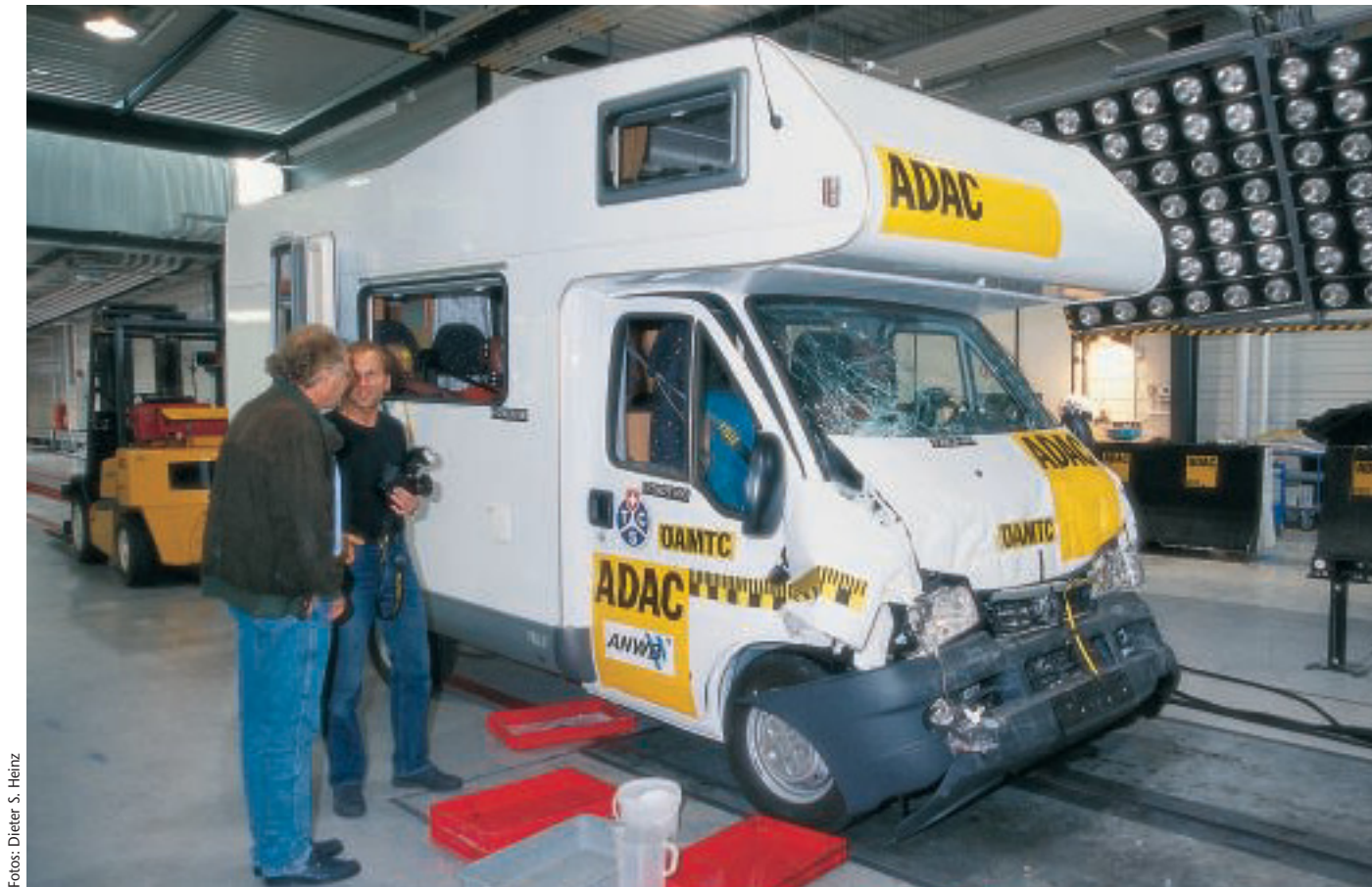
Der Aufprall hat die Front des Ducato demoliert, Reisemobil-Aufbau und Alkoven sind unbeschädigt.
