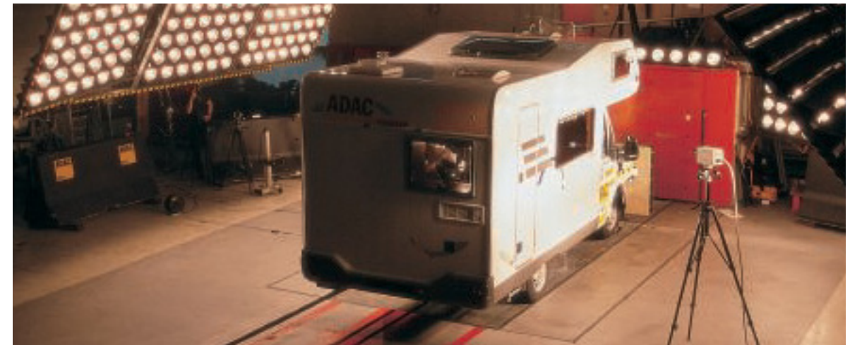
Den Aufschlag des Fahrzeugs auf die Barriere halten High-speed-Kameras in allen Einzelheiten fest. 2.000 Fotos pro Sekunde werden für die anschließenden Analysen gebraucht.
