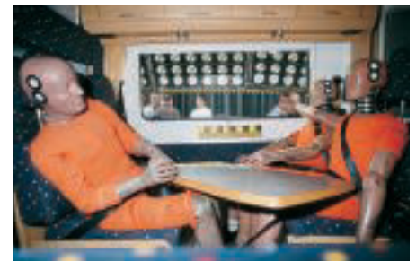
Den Belastungen des Crashtests haben weder Kühlschranktür noch Tischhalterung standgehalten.
