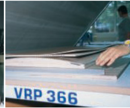
Verkleben einer Platte im Vakuum.
