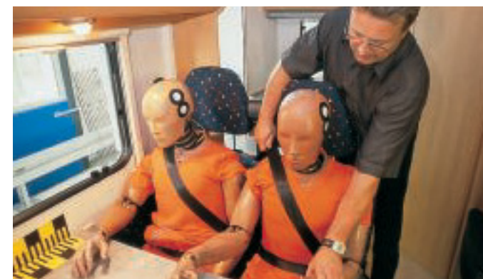
Die Dummys werden zuvor in eine praxisnahe Sitzposition gebracht.
