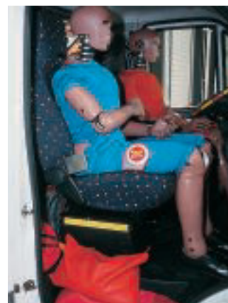
Dummys und Balastsäcke simulieren für den Crashtest Insassen und Beladung.
