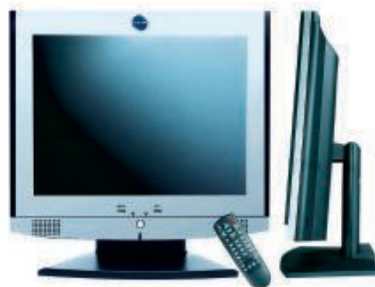
Mit einer Tiefe von 16 cm samt Fuß ist der 15"-TFT um einiges kompakter als der 40 cm tiefe Fernseher. Und während der Computermonitor 3,5 kg wiegt, bringt der Klassiker zehn Kilogramm auf die Waage.
