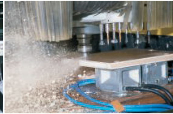
Bohren und Fräsen mit NC-gesteuerter Maschine.
