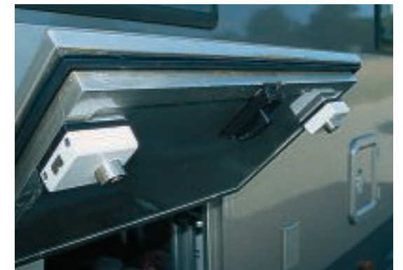
Mehrfachsicherung: Stauklappe eines Bocklet-Reisemobils mit zwei Zusatzschlössern.
