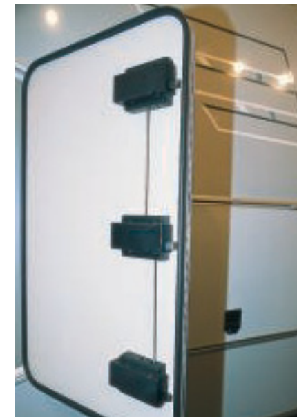
Dreifach gesichert: Heckgarage mit Schloss und Dreifachverriegelung.
