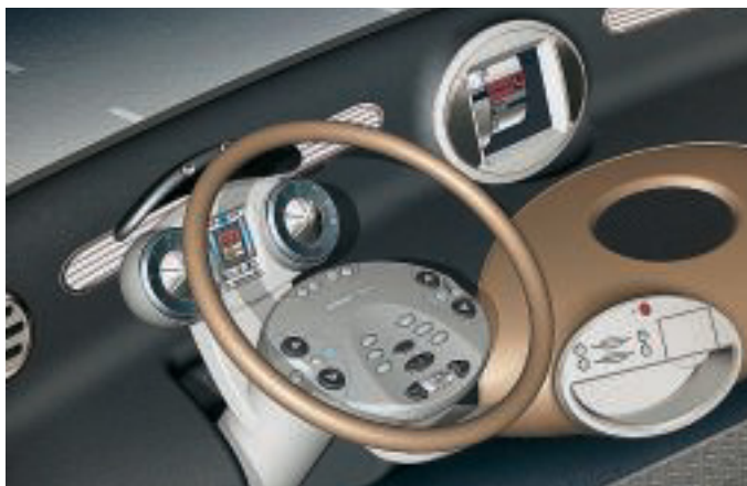
Bei der Cockpitstudie von Siemens-VDO bleibt die Prallplatte unter dem sich frei drehenden Lenkrad fest stehen.
