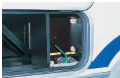
Ablasshähne der Versorgungstanks sitzen im Doppelboden.
