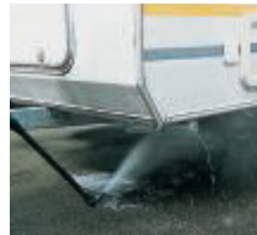
Mit Winkeldüsen lassen sich Unterboden und Dach des Mobils bequem erreichen.
