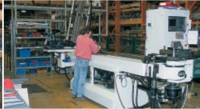
Multifunktions-Maschinen zur Leiternherstellung.
