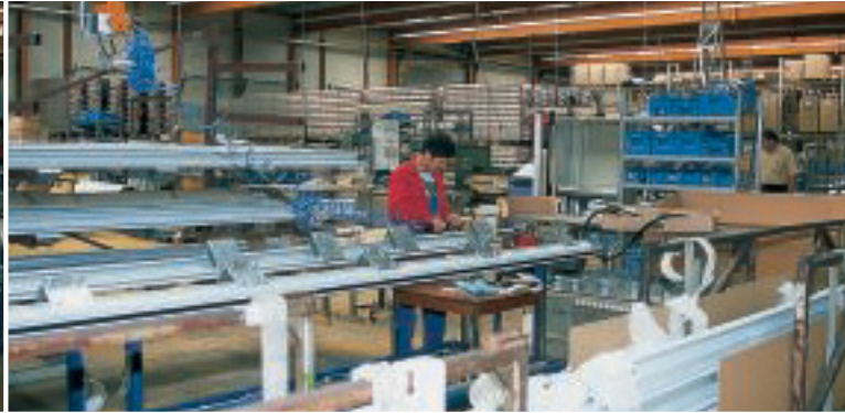
Anbringen der Leuchten und Lautsprecher an den Deckensystemen.
