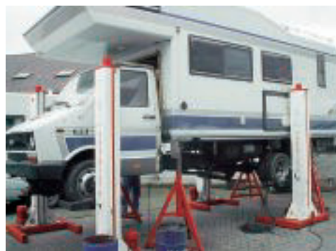
Eine Vierstempel-Hubanlage hebt das Reisemobil nach oben. Stützen tragen den Wohnaufbau.
