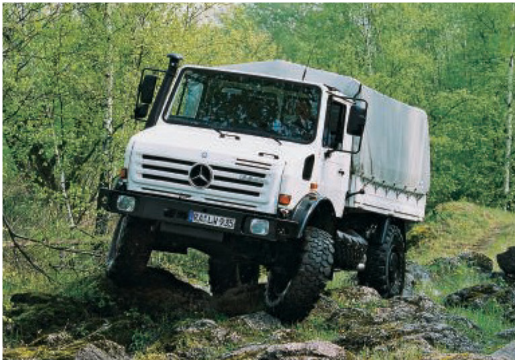
Die Verschränkung der Achsen und der verwindungsfähige Rahmen garantieren beste Geländegängigkeit.
