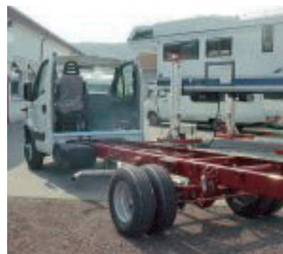
Das neue Chassis ist ausgeschnitten und durch eingeschweißte Profile verstärkt.
