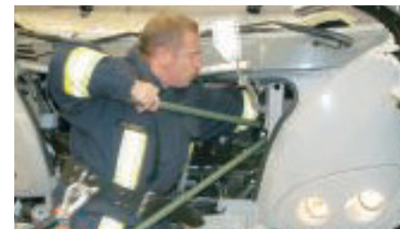
Untersucht: Hymer-Vorstand Claus Pacchiaffo und Projektgruppenleiter Klaus Voggel begutachten die Crash-Ergebnisse (oben). Der Haltegurt der hinteren Gasflasche hat sich geöffnet, der Boiler ist nach vorn gekippt, die Starterbatterie eingedrückt und muss abgeklemmt werden (links von oben nach unten).
