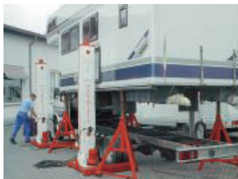
Unter dem abgestützten Wohnaufbau senkt die Hubanlage das Chassis auf den Boden ab.
