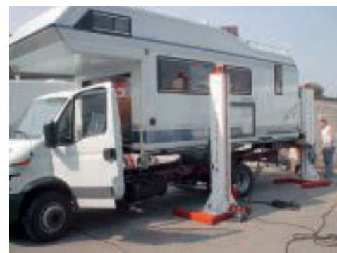
Die Hubanlage senkt den Wohnaufbau auf das neue Chassis ab.
