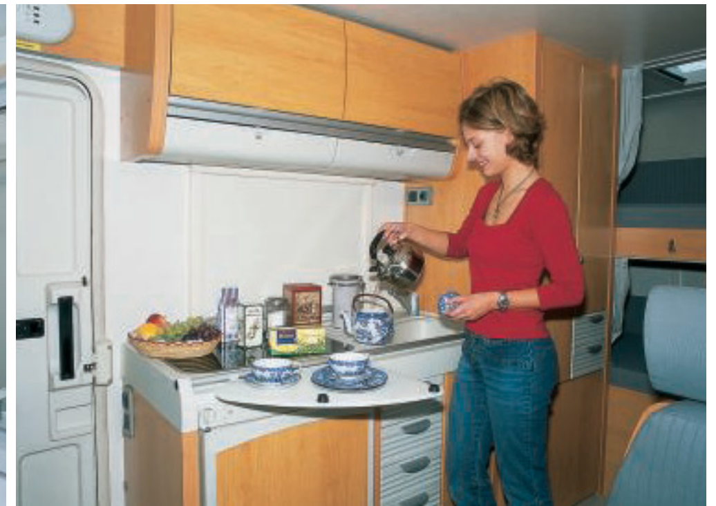
Praktisch: Das Waschbecken im Camp 524 lässt sich an der Alu-Säule schwenken. Die schieb- und klappbare Kunststoff-Platte erweitert die Arbeits- und Abstellfläche.
