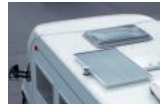
Gas sparen: warmes Wasser im Sunny Water durch Sonnenlicht.
