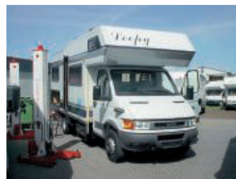
Bis auf Anpassungsarbeiten wie Beilackieren ist das Umsetzen beendet. Der Clou-Aufbau steht auf einem neuen Chassis.
