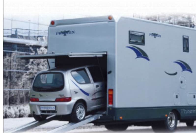
Bis auf Anpassungsarbeiten wie Beilackieren ist das Umsetzen beendet. Der Clou-Aufbau steht auf einem neuen Chassis.
