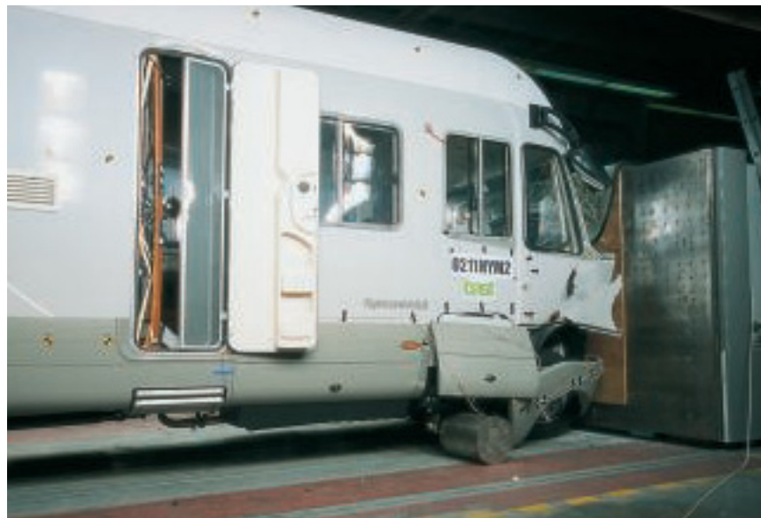
Zerknautscht: Während des Aufpralls knautscht die Front, die hintere Gasflasche rutscht heraus, die Wohnraumtür geht auf (oben). Ruhe nach dem Knall (unten).
