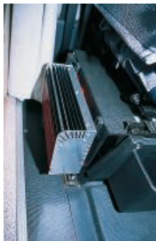
Detailliert: Ladegerät hinter dem Fahrersitz (oben) Wasser-Einfüllstutzen im Flaschenkasten (rechts oben) Abwasser-Ablauf mit Bajonettverschluss.
