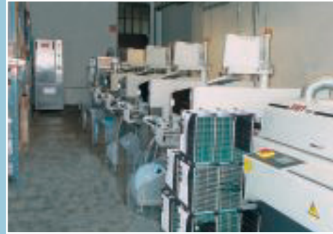
Automaten wickeln die für die Leuchten benötigten Transformatoren selbstständig.
