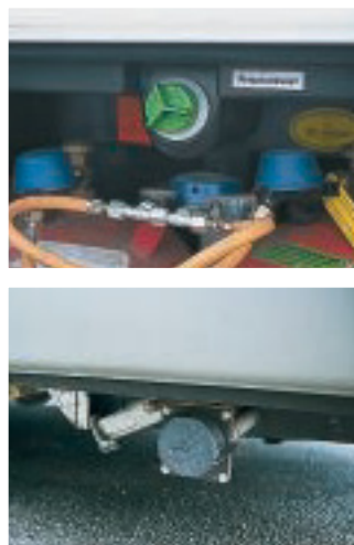
Detailliert: Ladegerät hinter dem Fahrersitz (oben) Wasser-Einfüllstutzen im Flaschenkasten (rechts oben) Abwasser-Ablauf mit Bajonettverschluss.
