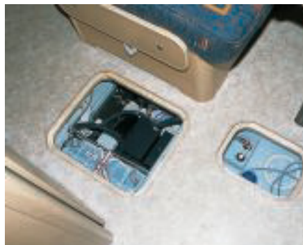
Elektroanlage und Frischwassertank im Serviceboden.
