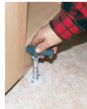
Der Abwassertank lässt sich von innen leeren.
