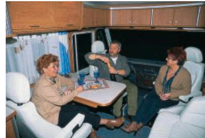
Gedreht: Zur gemütlichen Klörrunde werden die Fahrerhaussitze nach hinten gedreht und hydraulisch unterstützt angehoben.
