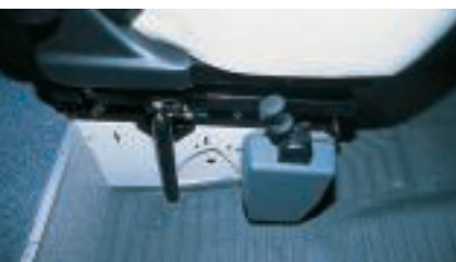
Unterstützt: Hinter dem Handbremshebel steht eine der Hydraulikstützen zum Anheben der Fahrerhaussitze.
