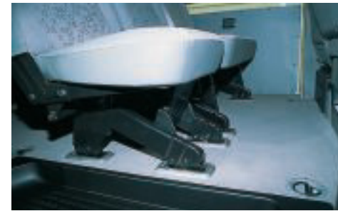
Starr: Die Sitzbefestigungen der Transporter sind nicht wie beim Multivan in Schienen verschiebbar.
