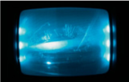
CABI: Die LED sind ungünstig angeordnet, so dass sie das Bild am Rand leicht überstrahlen.
