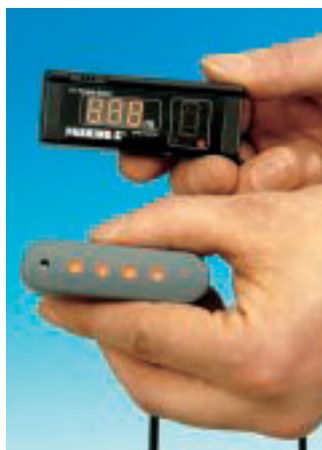
Einige Einparkhilfen zeigen den Abstand zum Hindernis in Meter an, bei anderen wechselt die LED-Farbe von Grün nach Rot.
