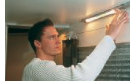
Leuchten in Alurohren, Vorhänge an Spanndrähten im Wohnwagen.
