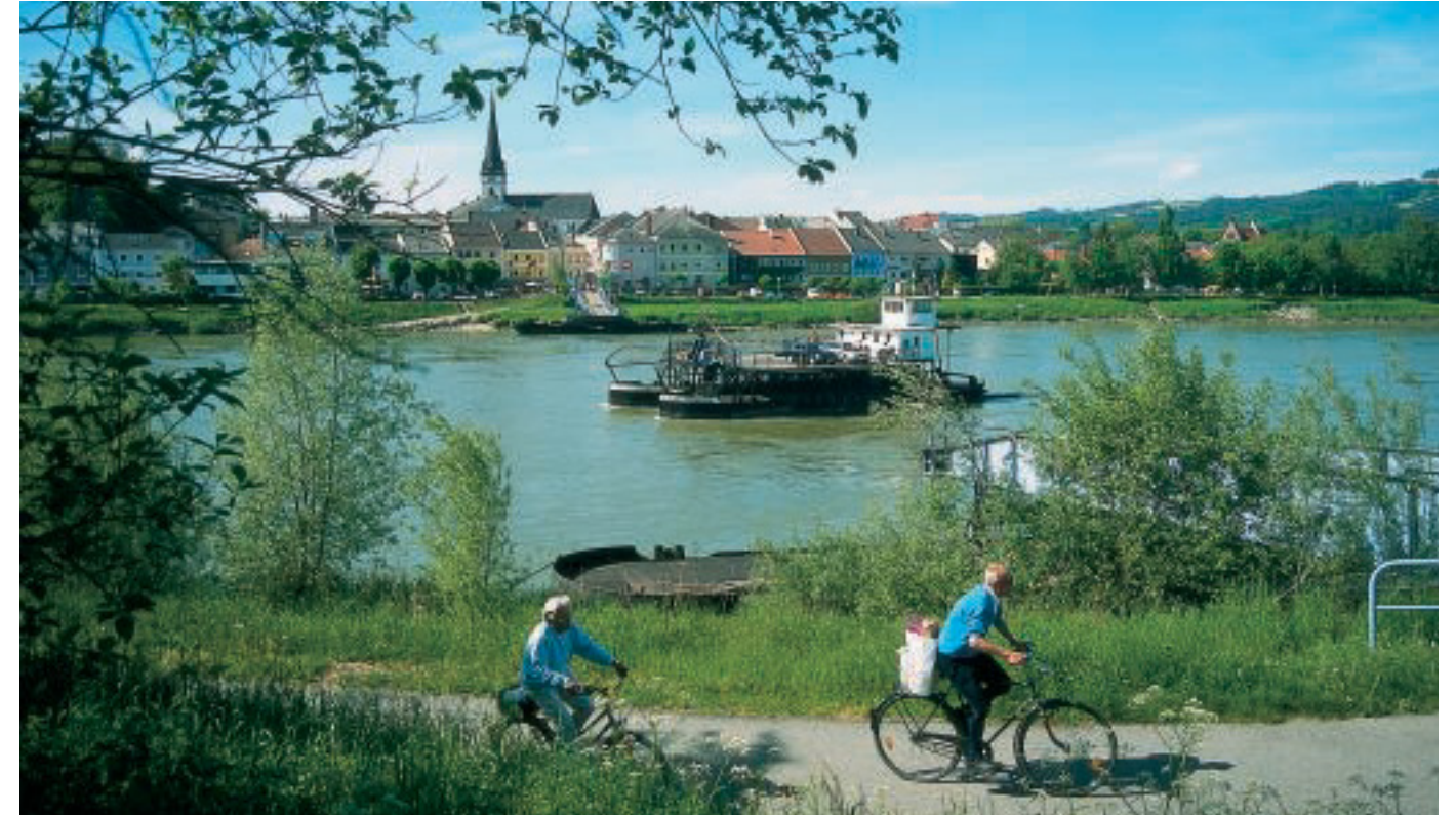
Antrieb durch die Strömung: Seilfähre auf der Donau bei Ottersheim.
