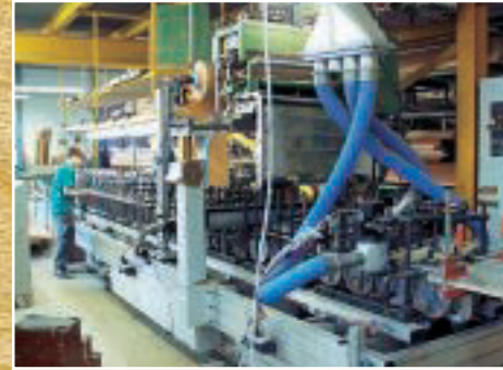
Die selbst gebaute Ummantelungs-Straße liefert 140 Meter Profilleisten in der Minute.
