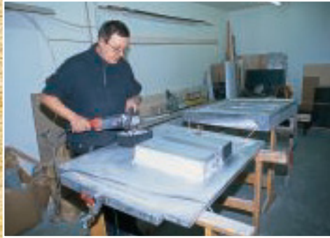
Im Werkzeugbau entsteht die Form für das Schäumen eines Aufnahmebodens für Frischwassertanks.
