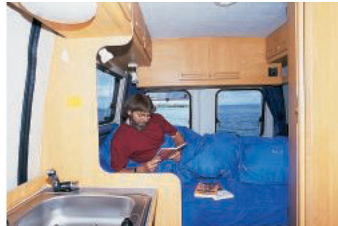
Ausgespart: Das Querbett im Heck kommt dank Aussparungen in der seitlichen Isolierung auf 194 Zentimeter Länge.
