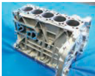
Starke Verrippung des Aluminium-Blocks soll Schwingungen und Geräusche minimieren.
