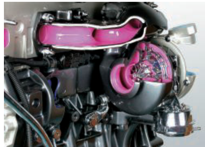
Lader direkt am Block verschraubt, neue Krümmer.
