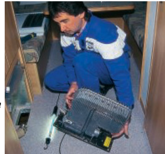
Pflegeleicht: Wärmetauscher und Abgasrohr müssen nun erst nach 30, nicht schon nach zehn Jahren ausgetauscht werden.
