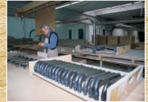
Handarbeit ist gefragt bei der Vorbereitung von Caravan-Rangiergriffen für die Lackierung.
