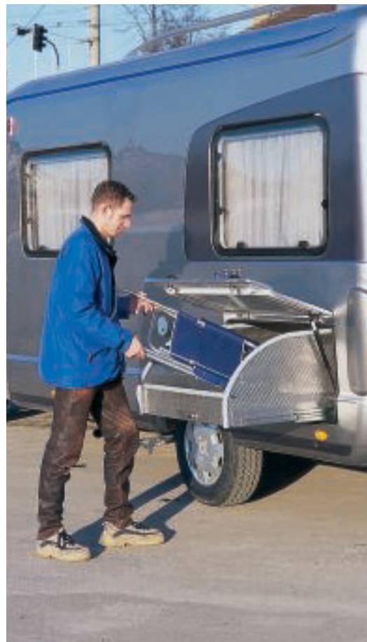
Laderaum: Die Campingmöbel finden in einem ausziehbaren Metallkorb, der im Außenstauraum unter dem Heckbett sitzt, ihren Platz. ►
