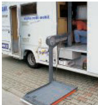
Umbauten: Erhöhter Innenboden von WVD Südcaravan Freiburg, Hydraulik-Lifteinbau von Hehn.
