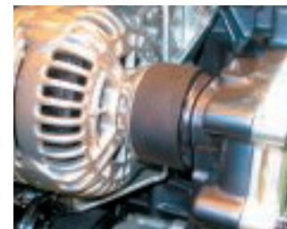
Eine Zahnriemenkupplung verbindet Nebenaggregate.
