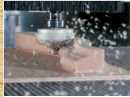
Die im eigenen Werkzeugbau gefertigten Fräser stellen auch ausgefallene Profilleisten her.
