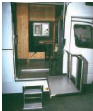
Kombi-Lösung: Ausklappbare Liftplattform neben normaler Einstiegsstufe bei Dopfer.
