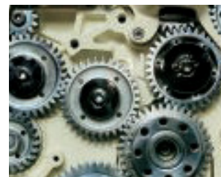
Anstelle des Zahnriemens treibt ein Stirnradatz die Nebenaggregate an.
