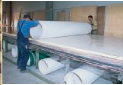
Ausgerollt: Vorbereitung einer zwölf Meter langen Wandplatte zur Verpressung.
