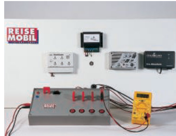
Der Versuchsaufbau: Die vier Gaswarner sind betriebsbereit auf einem Brett verschraubt. Die wichtigen Funktionen überwacht eine Mess-Elektronik.
