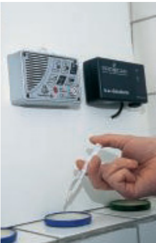
Der Test: Die narkotisierenden Flüssigkeiten werden nach Menge definiert in ein Schälchen getropft. Hier verdampfen sie – die Geräte reagieren.
