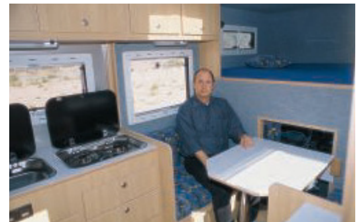
Abgenommen und in Führungen eingerastet, verschließt die Tischplatte den Durchgang zum Fahrerhaus.
