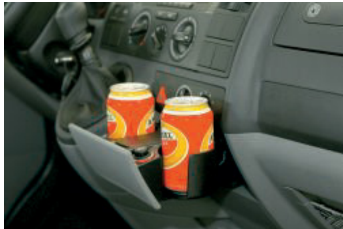
Unterhalb des Bedienfeldes ist ein Schubfach mit zwei Cupholdern und integriertem Aschenbecher eingebaut.
