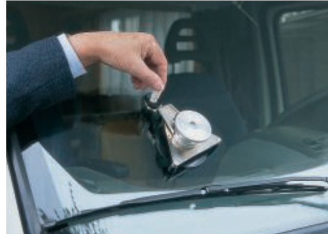
Geringer Aufwand: Ein spezielles Harz wird in das Loch gepresst. Später ist der Schaden kaum noch oder gar nicht mehr zu sehen.
