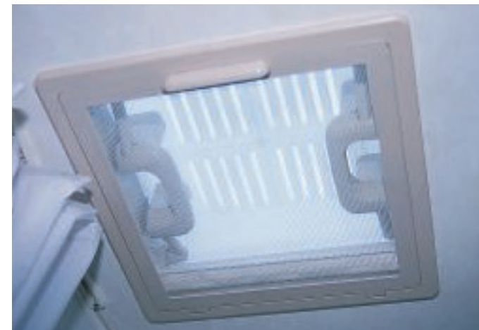
Verschiedene Systeme: Dachluken sind mit zieh- baren oder abklappbaren Fliegengittern ausgestattet.
