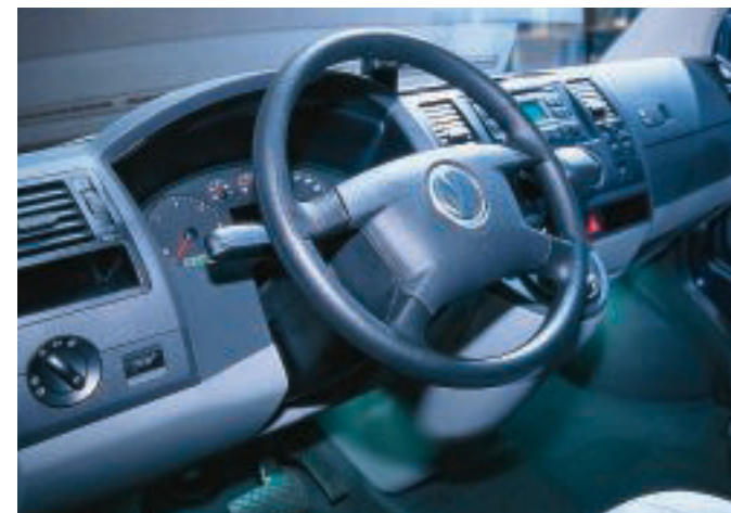
Das Lenkrad des Transporters lässt sich in der Höhe verstellen und enthält den Airbag.
