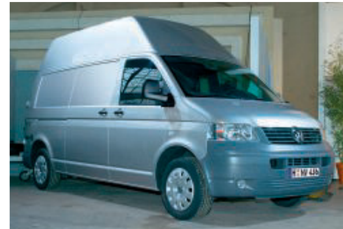
Der Transporter mit langem Radstand und Hochdach hat ein Laderaumvolumen von 9,3 Kubikmeter.
