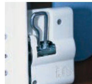
Bei geöffneter Aufbautür ist der Schließbolzen weggeklappt.
