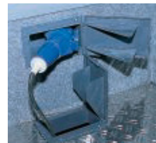
Über einen Bodendurchbruch wird die Leitung in die Heckgarage geführt.
