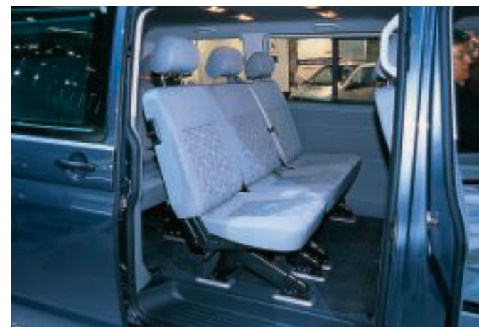
Der Shuttle ersetzt als Personentransporter das Modell Caravelle. Alle Sitzplätze im Shuttle sind mit Drei-Punkt-Gurten ausgerüstet.
