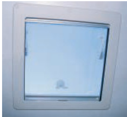
Verschiedene Systeme: Dachluken sind mit zieh- baren oder abklappbaren Fliegengittern ausgestattet.
