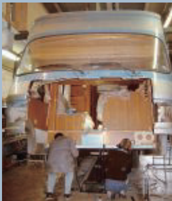
Das alte Fahrgestell ist sorgfältig abmontiert worden, die Öffnung vorbereitet.
