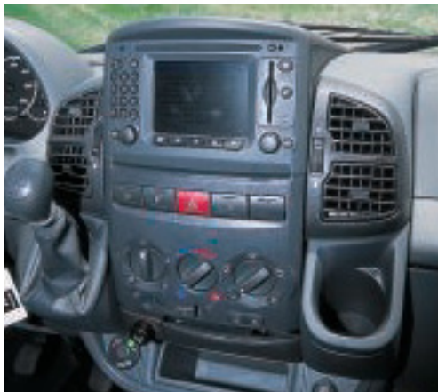
Per Knopfdruck Kraft auf die Hinterachse: Navigationskonsole und Schalter für den Allradantrieb am Armaturenbrett.
