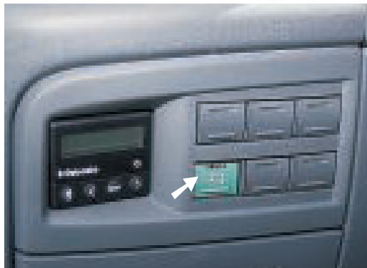
Per Knopfdruck Kraft auf die Hinterachse: Navigationskonsole und Schalter für den Allradantrieb am Armaturenbrett.
