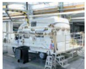
**Klemmzangen halten den frisch verklebten Exsis-Aufbau.**
