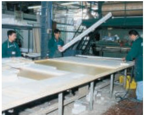
Bei Fachwerkwänden liegt die Holzkonstruktion auf der Spanholzplatte, welche die Innenseite der Wand bildet. Styroporplatten füllen dann die Zwischenräume aus.
