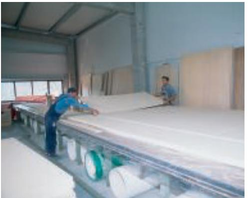
Bei Wänden ohne Fachwerk werden große Hartschaumplatten auf die Sperrholzplatte und notwendige Verstärkungsleisten in vorbereitete Nuten gelegt.
