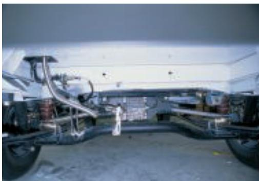
Allradantrieb durch zuschaltbare Hinterachse.
