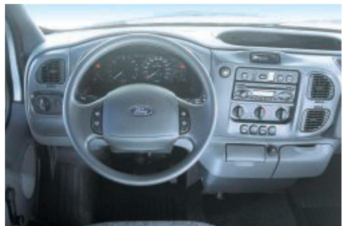
*Gewippt: Das Durashift-Getriebe bekommt seine Befehle am Armaturenbrett und am Lenkrad.*
