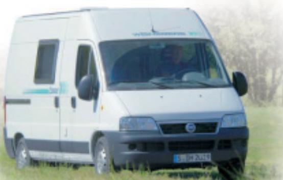
Ebenfalls neu sind die zwei Kastenwagen-Modelle 551 MQ und 551 K, mit denen Weinsberg zu seinen Wurzeln zurückkehrt. Beide Modelle sind Ausbauten des 3,3-Tonner Fiat Ducato 15 mit 370 Zentimeter Radstand und Serienhochdach. Der ab 33.520 Euro teure 551 MQ hat seinen Namen durch das
