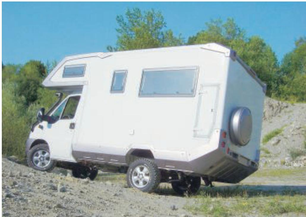
**Geländefähig:** Mit großen Böschungswinkeln, hoch gesetztem Aufbau und Allradantrieb mahlt der LEV durch die Kiesgrube.
