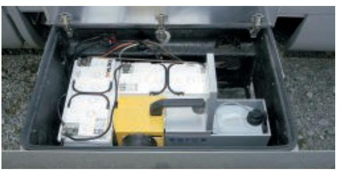
*Eine Brennstoffzelle lädt die beiden Bordbatterien.*
