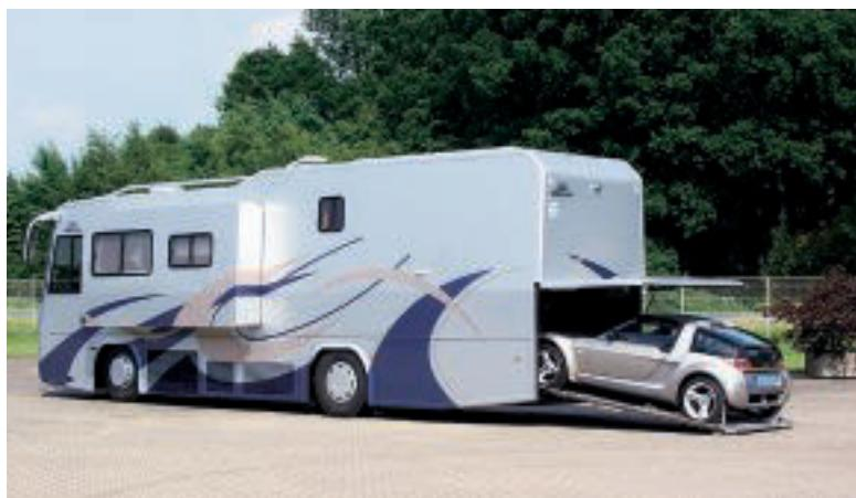
*Ausgefahren: Eine elektrisch betätigte Plattform übernimmt das Einziehen des Beiboots.*
