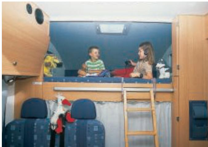
Die gegen Aufpreis lieferbare Spezial-Leiter zum Alkoven wird an einer Alu-Schiene geführt und verschwindet, wenn gewünscht, vollständig in einem schmalen Schrankfach.
