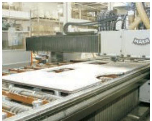
Nachdem die einzelnen Schichten miteinander verklebt sind, schneidet eine Fräse Radkastenausschnitte, Fenster- und Türöffnungen aus.
