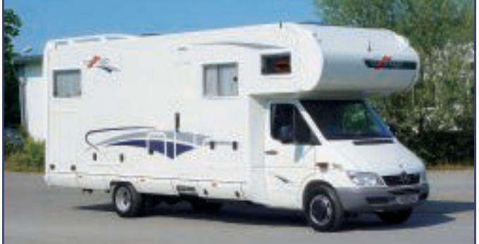
Mehr Platz gibt es zukünftig bei den Heckbetten, die auf 157 Zentimeter Breite angewachsen sind. Und auch unter ihnen ist mehr Raum für Fahrräder, Motorroller oder sogar Quads. Durch Rahmenabsenkungen erreichen die Heckgaragen Innenhöhen von immerhin 1,32 Metern.
