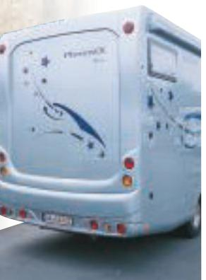
*Am Heck des Liners sind GfK-Elemente auf das Alu-Sandwich gesetzt.*
