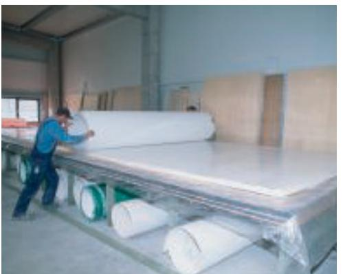
Die Außenhaut aus glasfaserverstärktem Kunststoff wird vom Coil abgerollt und mit dem PU-Dämmmaterial im Vakuum verklebt.
