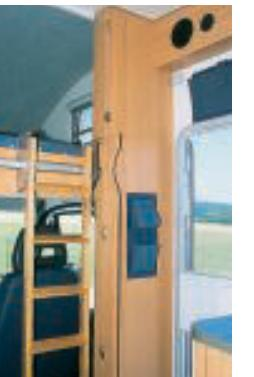
Die elektrischen Bauteile sind sauber zu einer Zentrale zusammengefasst.
