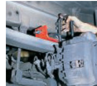
2. Das Halteblatt für die Schraubenfeder wird auf die Originalfeder aufgelegt.
