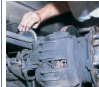
1. Nach dem Abnehmen der Räder werden die Federbriden gelöst und ausgebaut.
