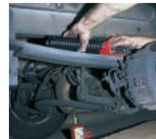
4. An das Halteblatt wird die Roadmaster-Schraubenfeder geschraubt.
