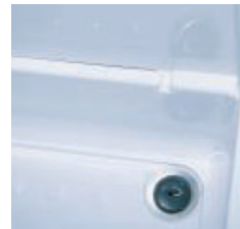
Die Duschwanne war im Testfahrzeug nicht komplett verfugt.
