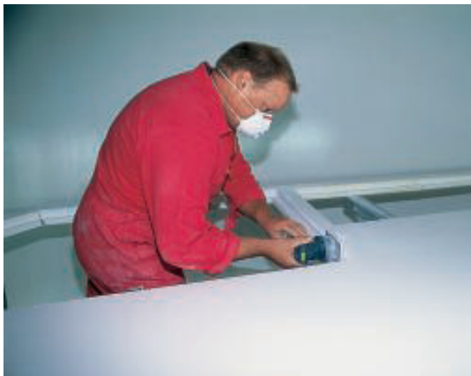
In mühevoller Handarbeit erstellen die Individual- und Expeditionsmobil-Produzenten die Stauklappen und deren Rahmen (Langer & Bock).
