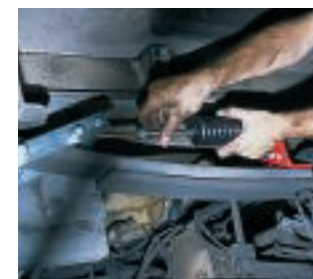
6. Eine Gewindestange verbindet die Schraubenfeder mit der Lasche.
