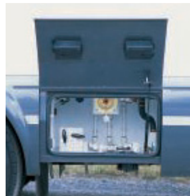
Ablasshähne und City-Wasseranschluss wurden in einem Außenfach installiert.
