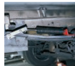
8. Fertig montiert verstärkt die Roadmaster-Zusatzfeder die Hinterachsfederung.
