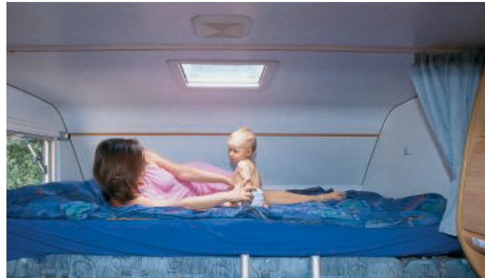
Frischluff ist im Alkovenbett des T.E.C. Rotec 580 M wegen der kleinen Dachluke und nur einem Ausstellfenster Mangelware.
