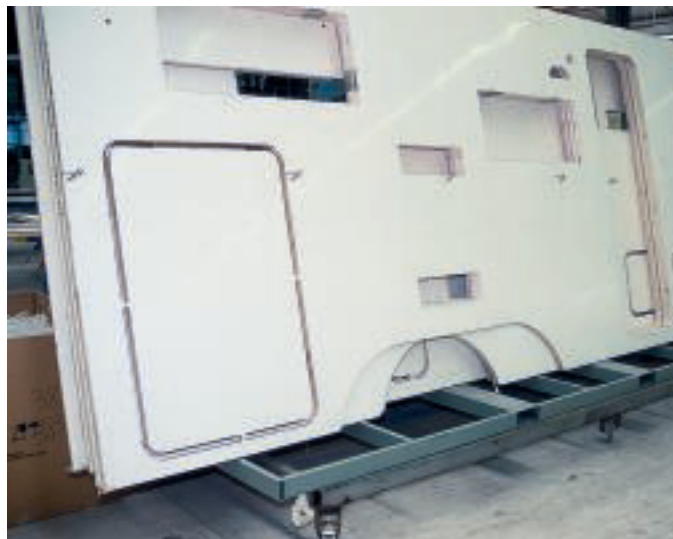
Deutlich sind in den von der Firma Mabel bei Eura Mobil angelieferten Wänden die vor-, aber nicht ganz ausgefrästen Stauklappen zu sehen.
