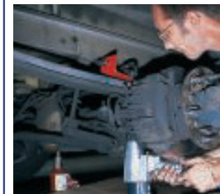
3. Mit neuen Bügeln wird das geänderte Federpaket zusammen geschraubt.
