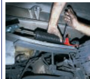
7. Mit Hand und Schraubenschlüssel wird die Zusatz-Schraubenfeder vorgespannt.
