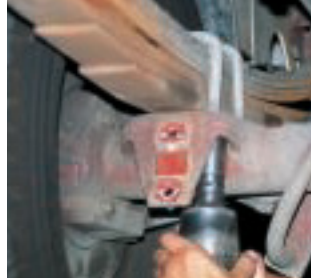
2. Bevor er das Federpaket entfernen kann, muss der Mechaniker auch die Federbriden lösen.
