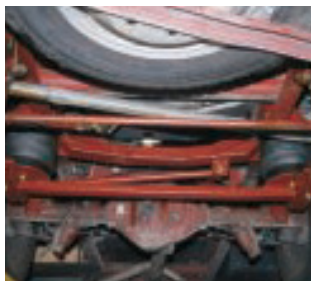
8. Zwischen den beiden Luftbälgen ist der leicht schräg eingebaute Panhardstab zu erkennen.
