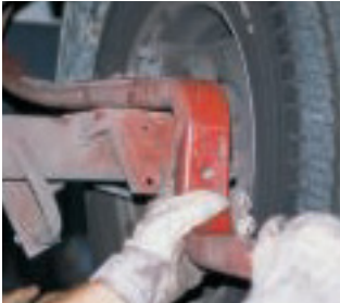
3. An Stelle der Blattfeder verbindet in Zukunft der z-förmige Längslenker Chassis und Achse.
