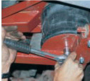
4. Der Werker verschraubt die beiden Luftbälge mit den Aufnahmetellern der unteren Traverse.
