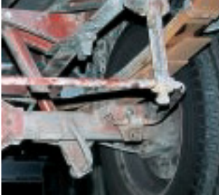
1. Die Blattfedern haben ebenso ausgedient wie die Stoßdämpfer. Der Stabilisator wandert nach hinten.
