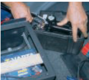
7. Ein Mechaniker schließt den Kompressor an und lässt ihn in der Sitzkonsole verschwinden.
