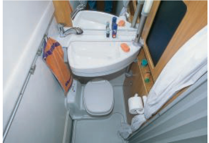
Das Waschbecken ist an der beleuchteten Stange hinten rechts aufgehängt.
