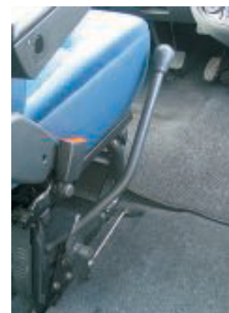
Nicht die Handbremse: Hier wird das Reduktionsgetriebe geschaltet.
