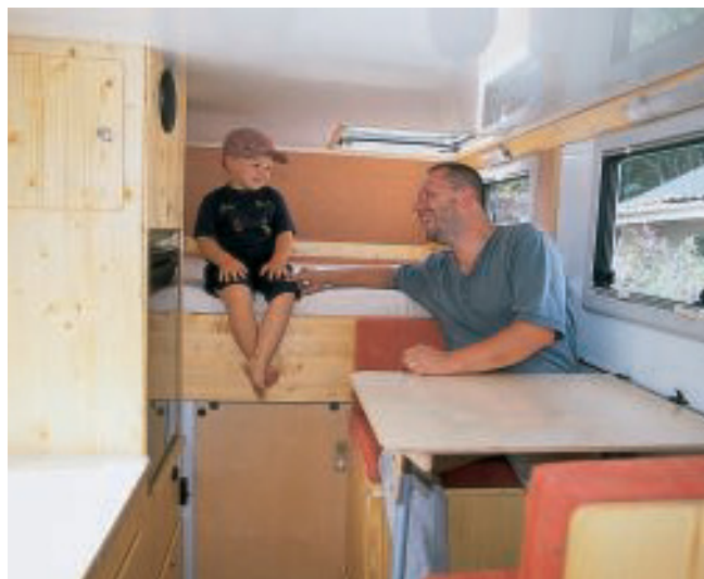
Den Möbelbau des Extrem-Pick-ups hat Thomas Lerner hell und freundlich gestaltet. Die zwölf Millimeter starken Fichte-Dreischichtplatten sind mit Wachs behandelt. Die Küche ist mit Spüle und Zweiflammkocher ausgestattet.
