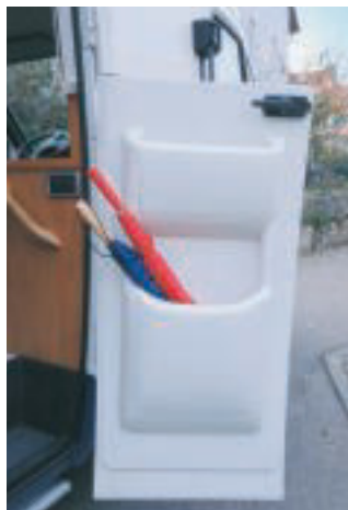
Die Taschen der Aufbautür sind anlaminiert und äußerst stabil.
