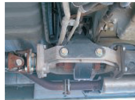
Die Visco-Kupplung und die De-Dion-Hinterachse sind entscheidende Bestandteile des Systems. Grün schaltet die Hinterachse zu, Braun die hintere Quersperre.
