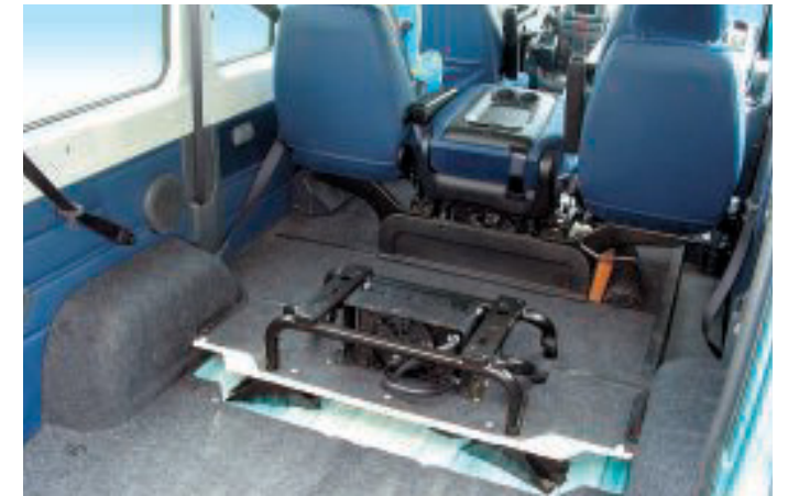
Der Ausbau der Sitzgestelle ist auf die Schnelle unmöglich. Die Flexibilität leidet.
