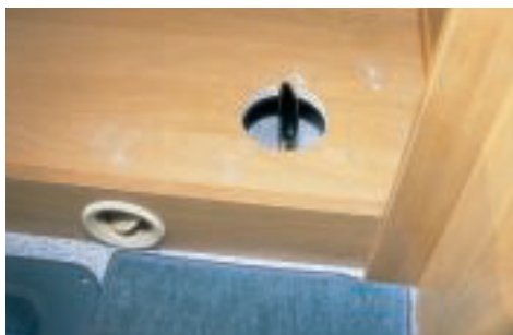
Einfallsreich: Absperrhahn für Abwasser innen liegend.
