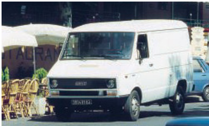
Den Ur-Daily von Iveco gab es mit 2,8 bis 4,2 Tonnen und 53 kW (72 PS). Das etwas kantige Design der Kabine (1978 – 1989) entsprach dem damaligen Zeitgeist.
