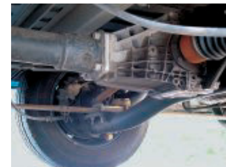
Die Visco-Kupplung und die De-Dion-Hinterachse sind entscheidende Bestandteile des Systems. Grün schaltet die Hinterachse zu, Braun die hintere Quersperre.
