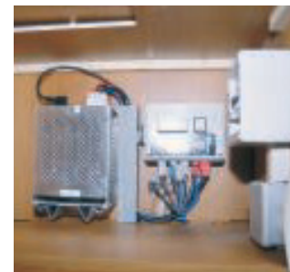
Die Elektrozentrale sitzt leicht zugänglich im Staufach.
