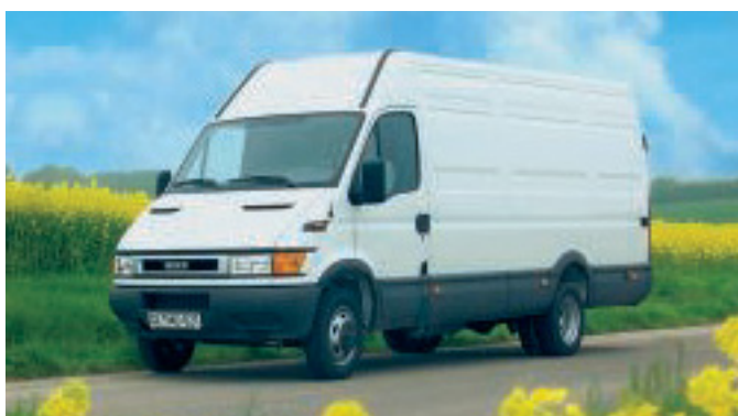
1999 wurde die aktuelle Baureihe Iveco Daily vorgestellt: 3,2 bis 6,5 Tonnen und 70 bis 108 kW/96 – 146 PS.
