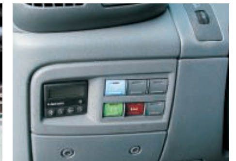
Die Visco-Kupplung und die De-Dion-Hinterachse sind entscheidende Bestandteile des Systems. Grün schaltet die Hinterachse zu, Braun die hintere Quersperre.
