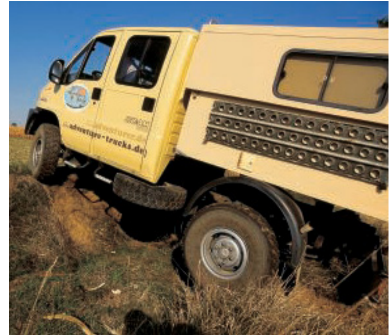
Kein Ducato, sondern eine Eigenentwicklung aus Italien: Der verwindungsfähige Rahmen ist für maximale Geländetauglichkeit entscheidend.
