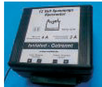
Konstant: Die Schaltung von Ardelt ermöglicht den Betrieb billiger Flachbildschirme an der Batterie.
