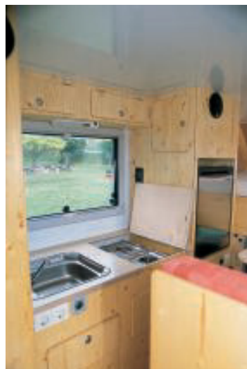
Den Möbelbau des Extrem-Pick-ups hat Thomas Lerner hell und freundlich gestaltet. Die zwölf Millimeter starken Fichte-Dreischichtplatten sind mit Wachs behandelt. Die Küche ist mit Spüle und Zweiflammkocher ausgestattet.
