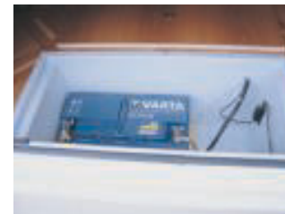
Die Bordbatterie wurde in einem Extra-Fach des Heckstauraums installiert.
