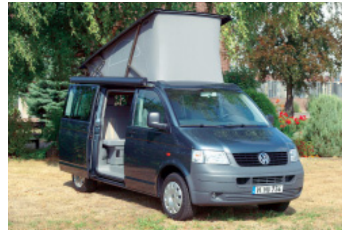
Steif, aber klappbar: Das Dach des VW California besteht aus Aluminium. Die Gewichtsersparnis liegt bei 25 Prozent.
