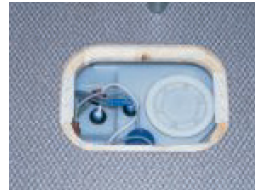
Der Frischwassertank ist im Service-Boden eingebaut und leicht zu warten.
