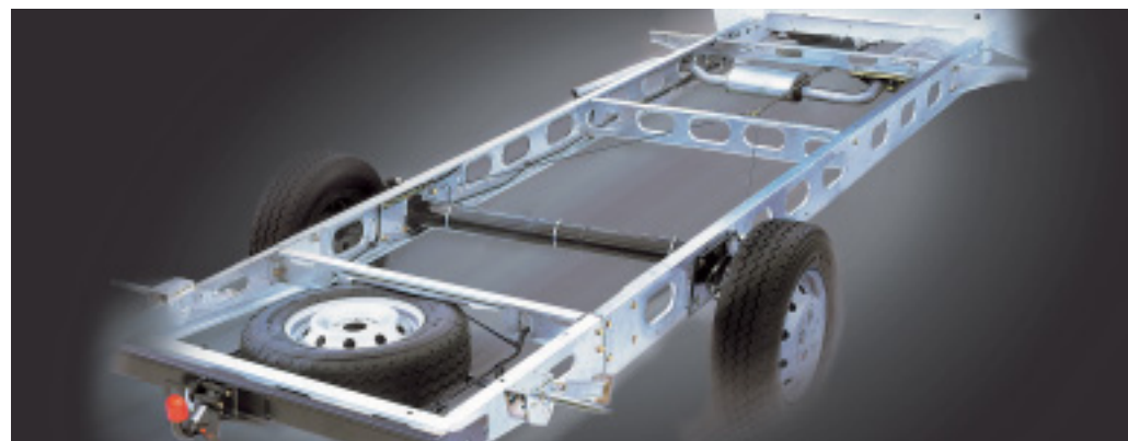
Lang, aber klar gegliedert: Beim amc-Leichtbauchassis spart Al-Ko Material und damit ordentlich Gewicht ein.
