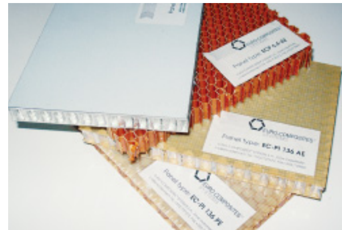
Kernig, aber stabil: Wabenplatten bieten einige Vorteile in puncto Leichtbauweise. Dennoch haben sie sich im Möbelbau noch nicht ganz durchgesetzt.
