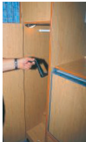
Das Dachbett wird per Handkurbel abgelassen.
