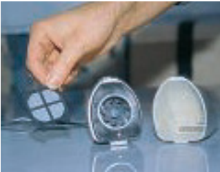
Der Filter der Powermaus, welcher Staubtopf und Motor trennt, hält den Schmutz nicht zurück.
