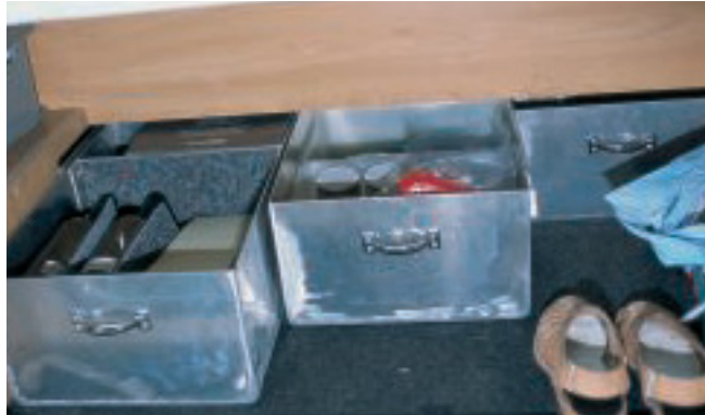
Selbst geschweißte Schubladen aus Aluminiumblech sorgen für Ordnung und sicheren Transport im doppelten Boden.
