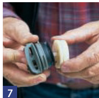
7 Ventil drücken und Schwimmer mit Drehung und leichtem Druck nach oben aushängen.
