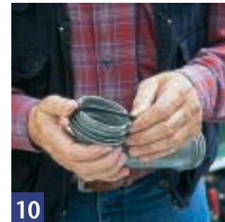
10 O-Ring am Stutzen und Dichtung am Deckel ersetzen und wieder aufsetzen.
