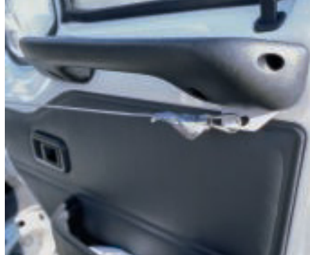
Kampf dem Einbruch: Das gespannte Drahtseil an den Fronttüren und der Metallstift in der Führungsschiene der Schiebetür geben zusätzliche Sicherheit.
