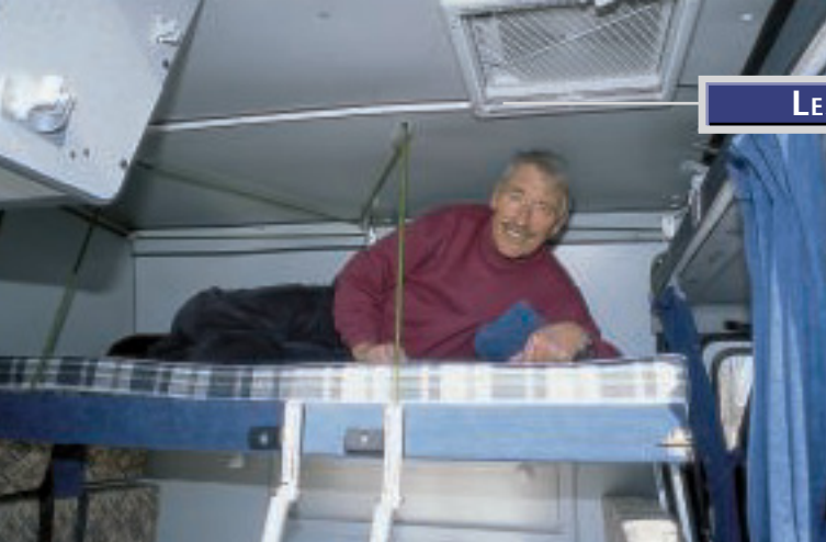
Eigenwillig: Die Aufhängevorrichtung des Hochbettes mit Bändseln, Seilwinde und Umlenkrollen ist außergewöhnlich, aber zweckdienlich.
