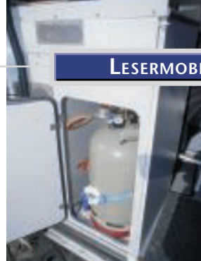
Durchdacht: Der Gasflaschenkasten wurde in die Küchenzeile integriert, der Kleiderschrank im Heck ist mit extra Wäschefächern versehen.
