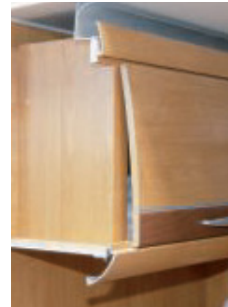
Folierte Aluprofile ermöglichen vielfältige Formen. Das Heck stammt aus der erfolgreichen Esprit-Baureihe von Dethleffs.
