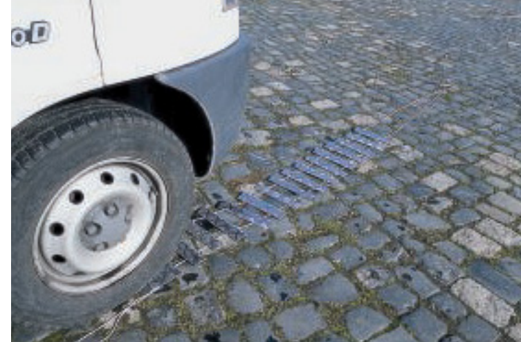
Pfiffig: Eine selbst konstruierte, zusammenrollbare und damit Platz sparende Anfahrhilfe ersetzt ein sperriges Sandblech.
