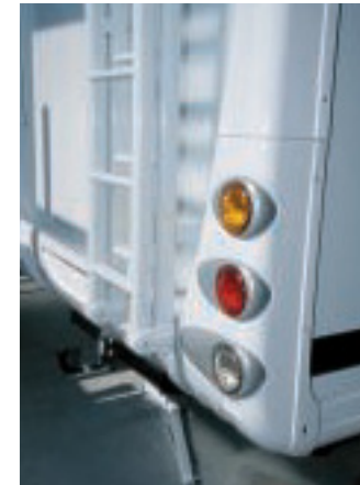
Folierte Aluprofile ermöglichen vielfältige Formen. Das Heck stammt aus der erfolgreichen Esprit-Baureihe von Dethleffs.
