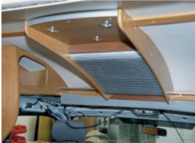
Zentral zwischen den beiden Frontsitzen ist ein flacher Dachstauschrank montiert, der das sonst übliche Fernsehfach ersetzt.
