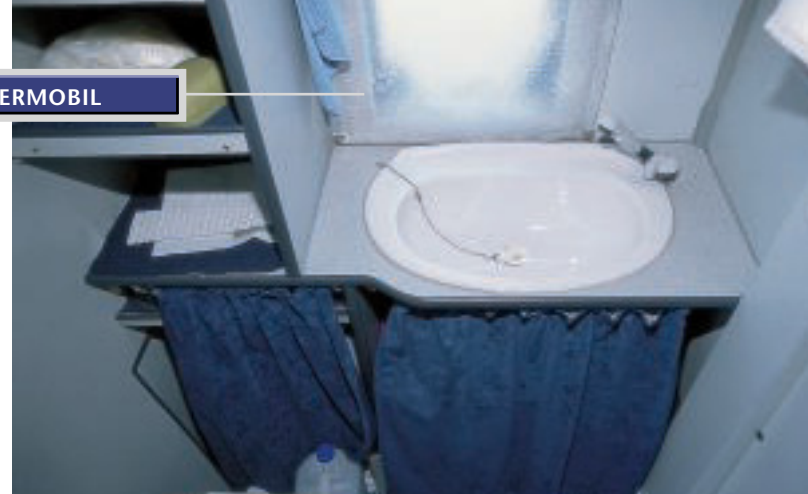
Kompakt: Die Sanitärzelle ist trotz bescheidener Abmessungen mit Kunststoffwaschbecken, Waschtisch, Porta-Potti und Wandschrank absolut praxismgerecht eingerichtet.
