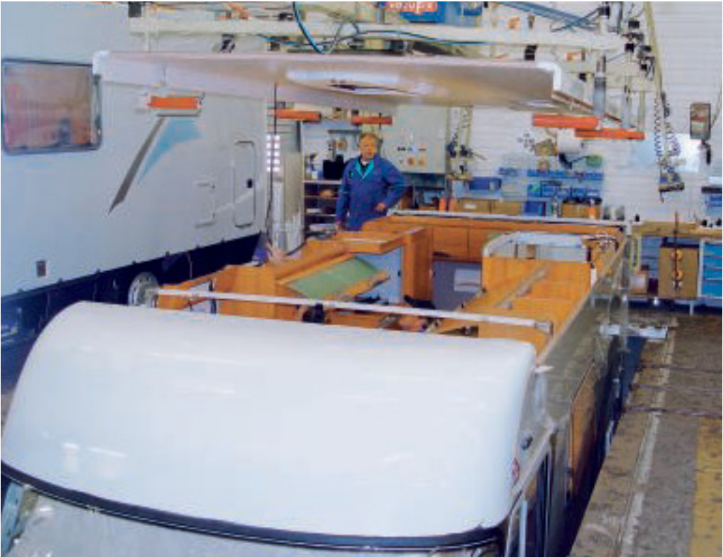
Kleben: Hymer legt das Dach in die vorbereiteten Klebezonen und füllt nach dem Ausrichten die Fugen mit elastischem Kleber. Zu diesem Vorgang des so genannten Stumpfverklebens kommen noch umlaufende Regenleisten.
