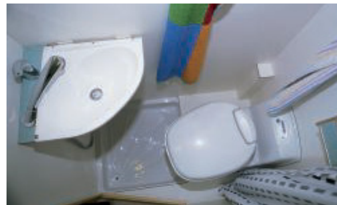
Klappbar: Zum Duschen lässt sich das Waschbecken an die Rückwand klappen.
