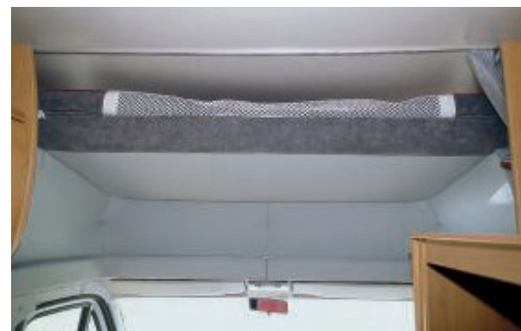
Zum Hochklappen: Als Hubbett konzipiert, fährt die Alkovenliege bei Bedarf nach oben, was den Durchgang ins Cockpit erleichtert.
