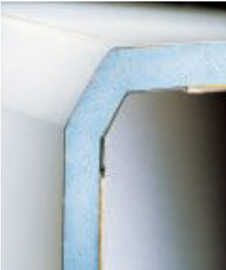
Design, unterschiedlich gelöst: Niesmann+Bischoff verklebt die geschlitzten und umbogenen Sandwichplatten überlappend (links), EuraMobil benutzt ein zweiteiliges Eckprofil (Mitte), Laika klebt ein Rundprofil über die verschraubten Teile.
