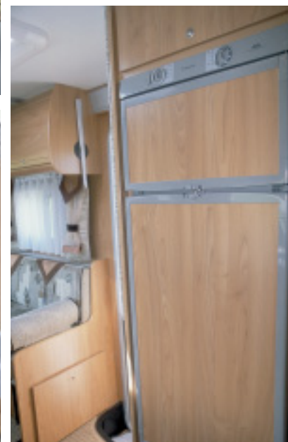
Detailliert: Offener Fahrerhaus-Überbau mit Fach für Flachbildschirm (links), Winkelküche (darunter) und Riesenkühlschrank (unten).
