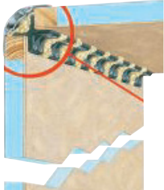
Design, unterschiedlich gelöst: Niesmann+Bischoff verklebt die geschlitzten und umbogenen Sandwichplatten überlappend (links), EuraMobil benutzt ein zweiteiliges Eckprofil (Mitte), Laika klebt ein Rundprofil über die verschraubten Teile.
