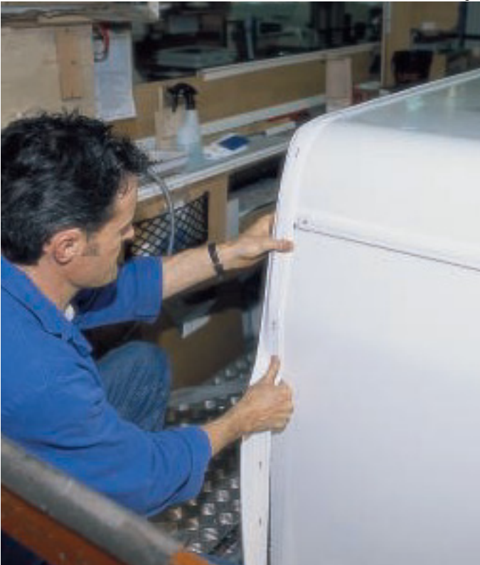
Schrauben: Sobald Wände und Dach verbunden sind, wird das mit Dichtmasse versehene Eckprofil montiert und in eine Fuge die Dichtlippe eingezogen.
