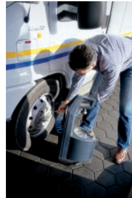
Eine dem Luftdruck angepasste Beladung minimiert den Rollwiderstand.
