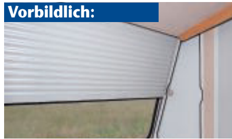
Der elektrische Iso-Rollladen der Panorama-Windschutzscheibe.
