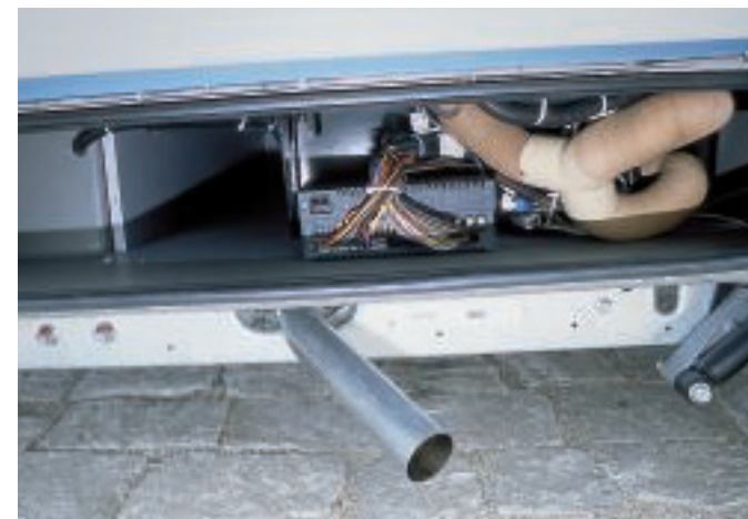
Tanks und Elektrozentrale sitzen im doppelten Boden.
