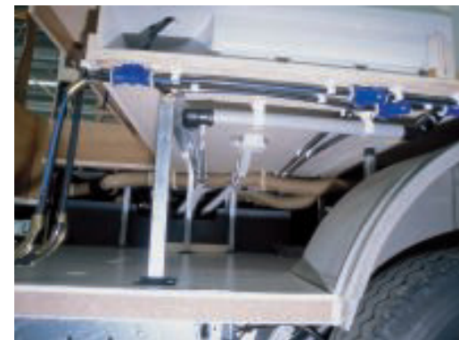
Aufgeräumt: Doppelboden mit neuen Stützen und Rohrleitungs-Wassersystem.
