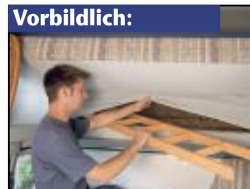
Vorbildlich: Die Aufstiegsleiter zum Alkoven verschwindet unter der Matratze.
