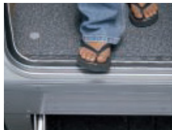
Die Gummidichtung wird durch ein Blech geschützt.
