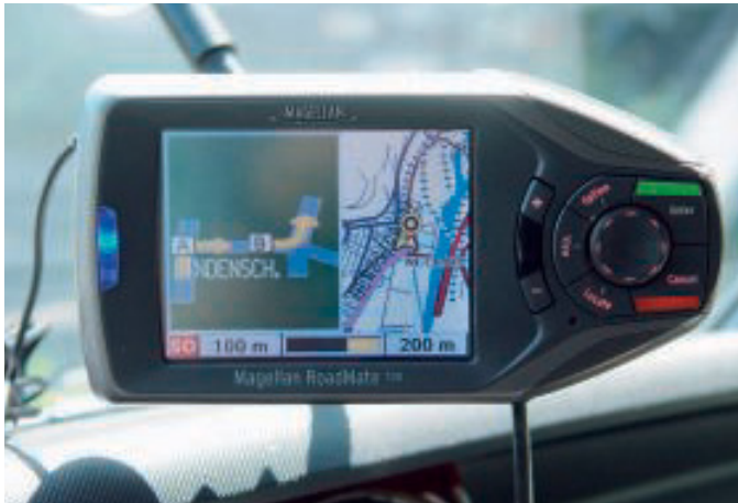
Kreuzungszoom und geteilter Bildschirm des Magellan RoadMate erleichtern die Orientierung. Der Schwanenhals lässt das Gerät jedoch schwanken und bei Berührung gar ausweichen.
