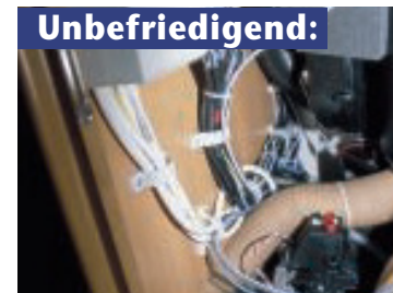
Der Kabelsalat im Heizungsfach unter dem Kleiderschrank.
