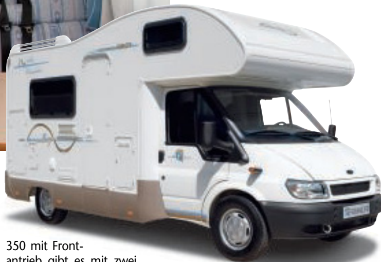
Basis des kleinen Alkoven-Mobils ist das Ford-Transit-Flachbodenchassis mit Frontantrieb.
