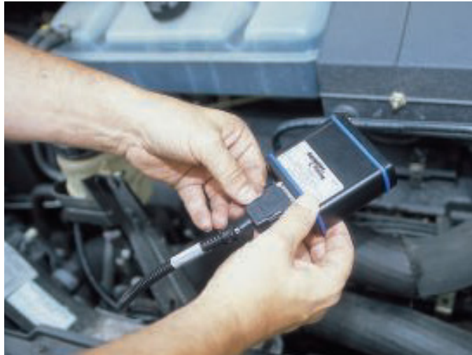
Box am Kabelsatz anstecken und befestigen: Beispiel für Box am Common Rail.
