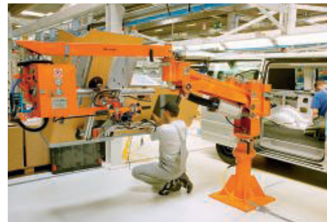
Viele Arbeitsabläufe werden von Robotern unterstützt. So wird beispielsweise das ganze Küchenmodul hochgehalten und zur Montage gedreht und geschwenkt. Geschulte Mitarbeiter überwachen die Abläufe.
