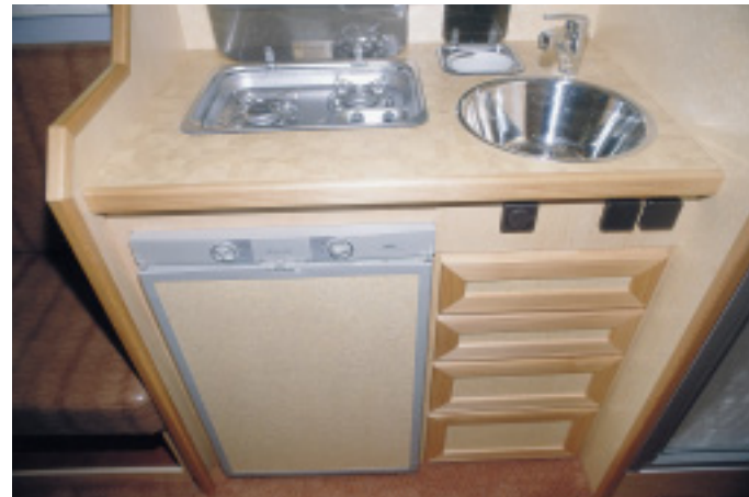
Ungewöhnlich: Verbundmaterialien als Möbelplatten und leichtestes Edelholz für Klappenrahmen.
