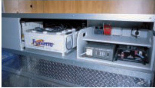
Einwandfreie Installation: Gelbatterien, Ladegerät und Spannungswandler sind gut zu erreichen. Formteile halten die Gasflaschen für.
