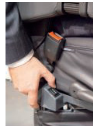
Der künftige Fahrerhaussitz von Sportscraft lässt sich elektrisch in der Höhe verstellen.
