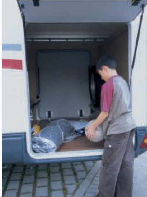
Gasdruckstoßdämpfer halten die beiden Klappen der Heckgarage offen.
