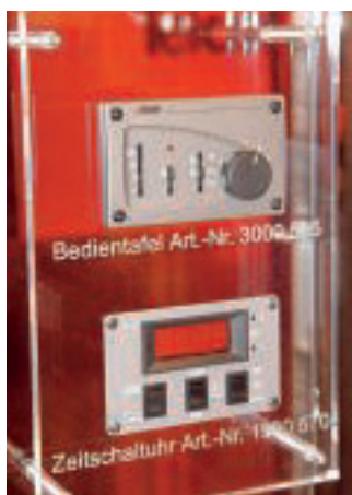
Mit der Zeitschaltuhr bietet die Alde-Zentralheizung eine Nachtabsenkung.
