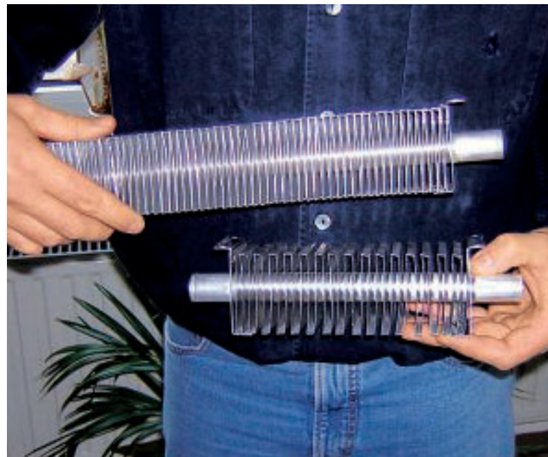
Die Leistung der Wasserheizung lässt sich über die Länge der Konvektoren und die Dichte ihrer Bleche beeinflussen.
