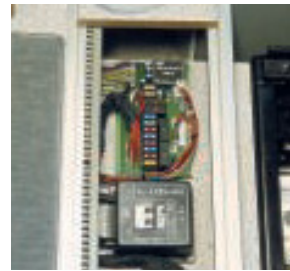
In einem Kanal hinter den Frontsitzen befindet sich die elektrische Anlage.
