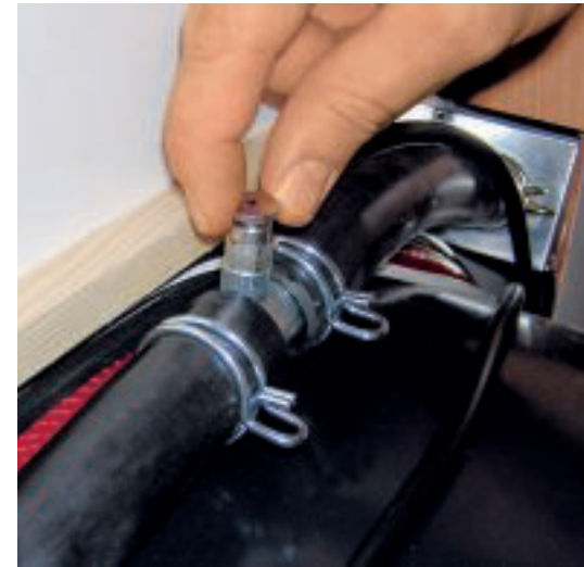
In den Leitungen der Wasserheizung sammelt sich Luft, die regelmäßig an Entlüftungsschrauben abgelassen werden muss.
