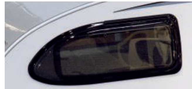
Gestaltet: Freiformfenster geben Designern die Möglichkeit, Acryl-Flächen unabhängig vom Wandausschnitt in Form zu bringen.
