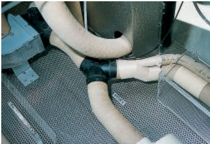
Über Abzweigungen verteilt das Rohrleitungssystem die warme Luft an mehrere Stellen im Reisemobil.
