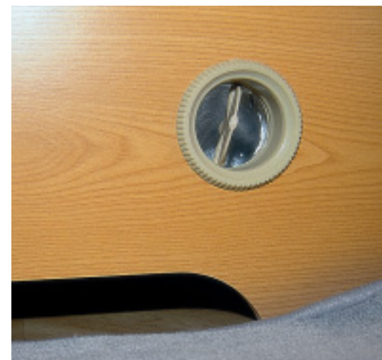
Der verstellbare Luftausströmer und der Möbelausschnitt müssen frei bleiben, um die Luftzirkulation nicht zu stören.
