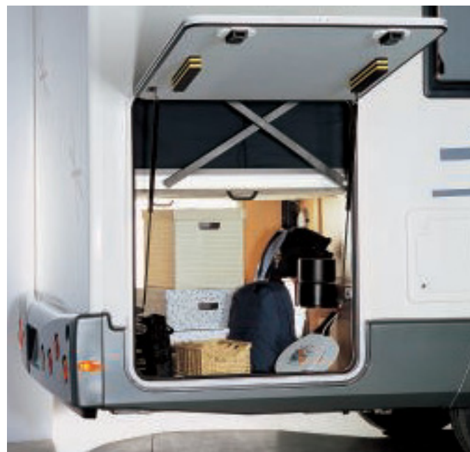
Ein Scherenmechanismus unterstützt die Hubbewegung des Betts.
