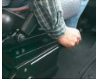
Die Handbremse rastet unabhängig vom Hebel ein.
