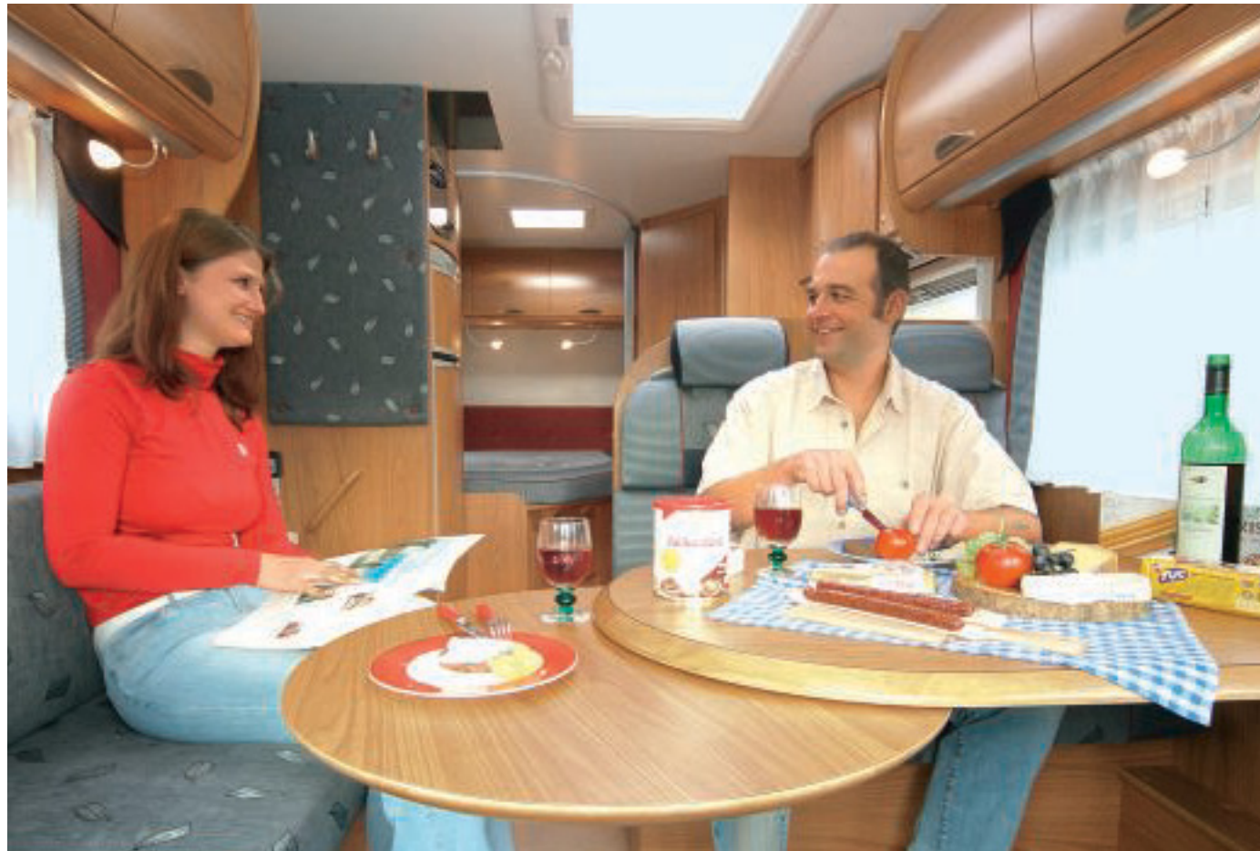
Mitgedacht: Dank ausschwenkbarer Verlängerung lässt sich der Tisch von jedem Sitzplatz der Dinette aus nutzen.
