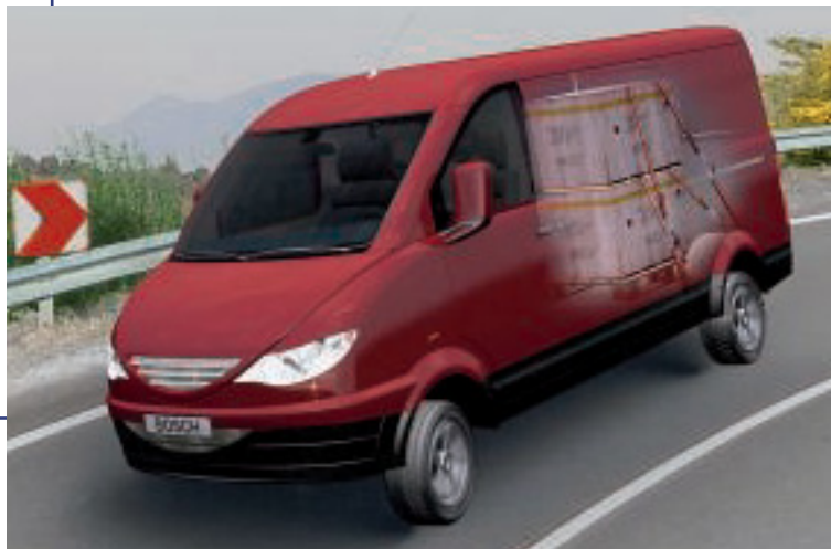
Für leichte Nutzfahrzeuge: Das neue System von Bosch passt die ESP-Eingriffe auch an die Schwerpunktlage des Fahrzeugs an.
