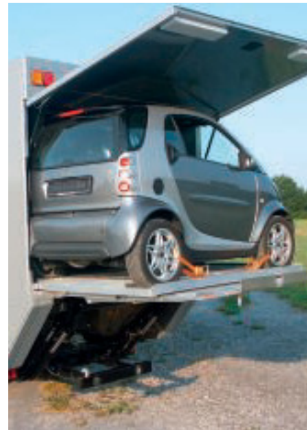
Mit Hilfe der Ladebordwand wird der Smart ins Gepäckabteil gehievt.
