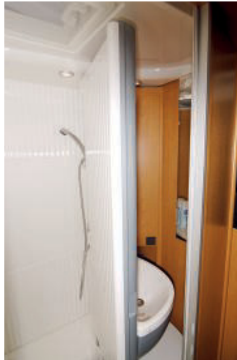
Klappmechanismus im Bad: Wer die Rückwand inklusive Waschbecken zur Seite klappt, erhält eine Duschabtrennung. Zusammen mit einem Kunststoffelement aus der Tür entsteht ein Spritzschutz.
