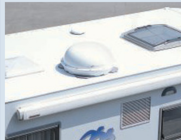
Unter der Kuppel auf dem Fahrzeugdach verbirgt sich, vor Wind und Wetter geschützt, die Antenne von Camos, die sich kontinuierlich auf den Satelliten ausrichtet.
