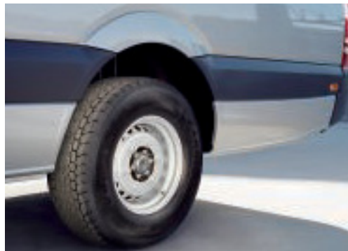
Breit: Die 4,6-Tonner-Modelle rollen auf Supersingle-Reifen der Dimension 285/65 R 16 C an der Hinterachse.
