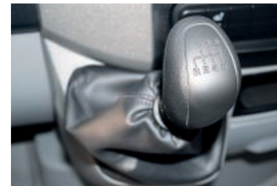
Griffgünstig: Der Joystick-Schalthebel des Sechsgang-Getriebes ragt direkt neben dem Lenkrad aus dem Armaturenbrett.
