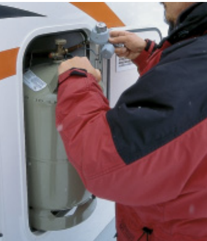
Ärgerlich: Der Gasflaschen-Kasten ist zu niedrig und zu eng.
