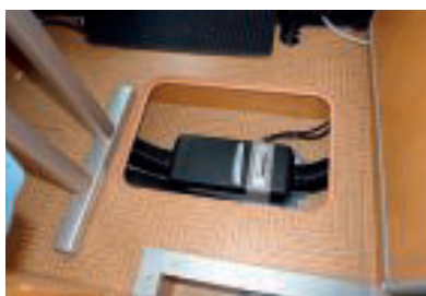
Die Webasto-Dieselheizung werkelt in dem vorderen Podest unter der Halbdinette. Die Klappe des Wasseranschlusses ist abschließbar.
