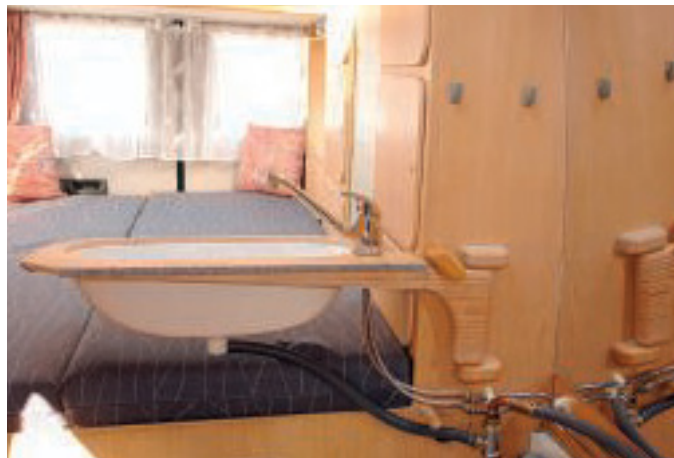
Den Schwenkmechanismus hat Willi Hornemann selbst gebaut. Nur so sind solche individuellen Einbauten erschwinglich.
