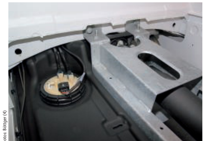
Angepasst: Selbst den 80-Liter-Dieseltank hat Mercedes-Benz maßgenau in das Chassis eingepasst.
