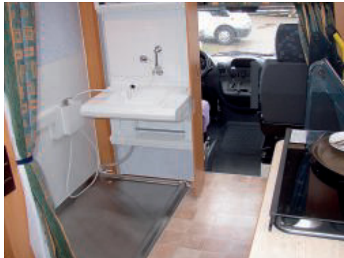
Hehn Mobil baut den Five Star (63.750 Euro) mit der Außenhaut aus Alu-Wabenkern-Platten. Merkmale des Hehn Top Star 630 HS: Duschbad mit Edelstahlwanne, klappbares Waschbecken, unterfahrbare Küche.
