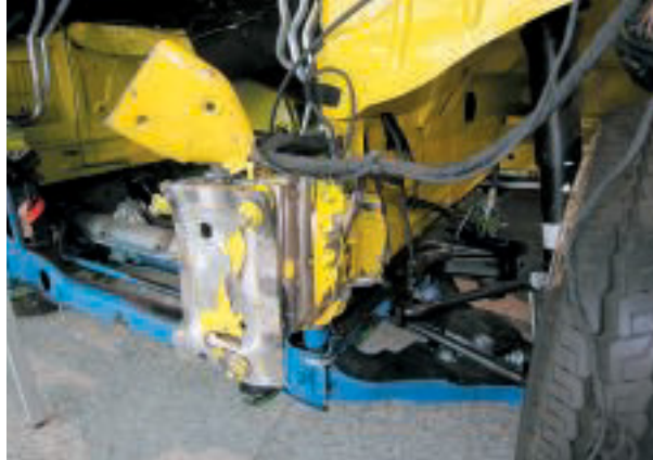
Gestaucht: Der Rahmenlängsträger nimmt mit seiner Deformation die Masse der Crash-Energie auf.
