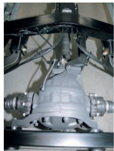
Verschraubt: Die speziell konstruierte Radaufhängung (ganz oben) und das festgelegte Differenzial (oben) sitzen in einem Achsschemel.
