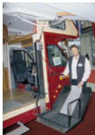
Der elektrische Selbstfahrer-Rollstuhl des Grimm Rolli Mobil 8 hat 350 Kilogramm Tragkraft. Die breite Klappentür schwenkt Platz sparend nach oben.
