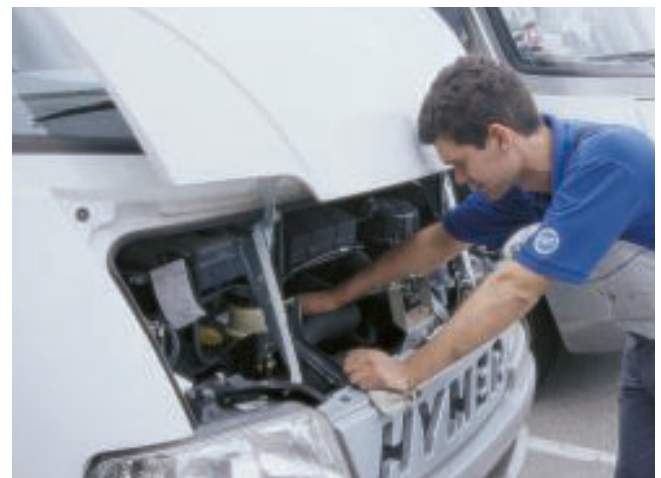
Aufgespürt: Auf Anhieb fand der Fiat-Werkstattleiter in Sonthofen, warum der Turbo-Dieselmotor den Exsis nur noch auf 70 km/h brachte. Der Kabelbaum für die Magnetventile war defekt.
