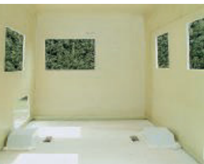
Laminiert: Die Wohnkabine wird von einem Yachtbauer in einem Stück hergestellt.
