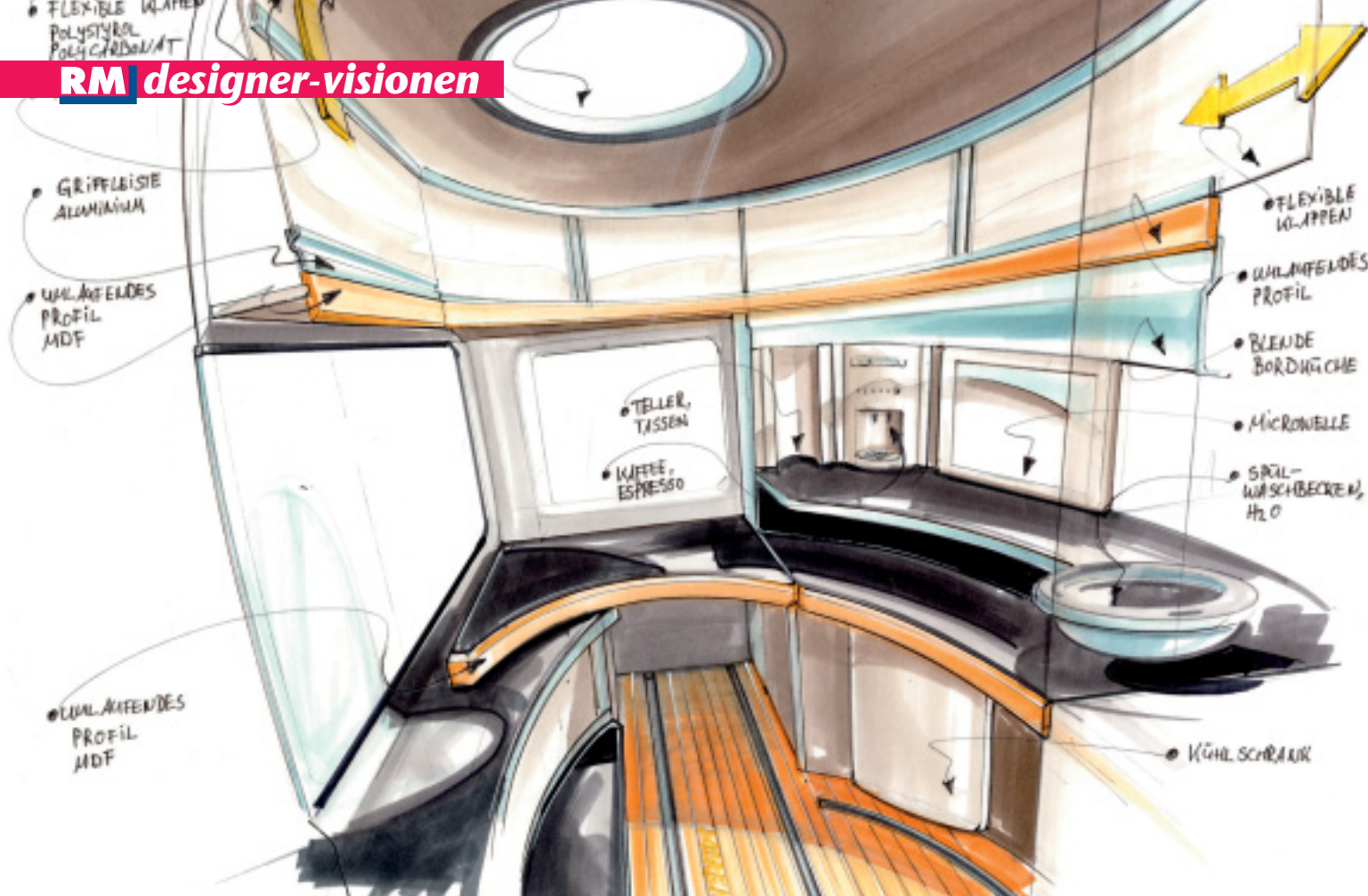
Aufgeklappt: Ein angeschraubtes Funktionsmodul erweitert das Outdoor-Mobil zur Wohneinheit.
