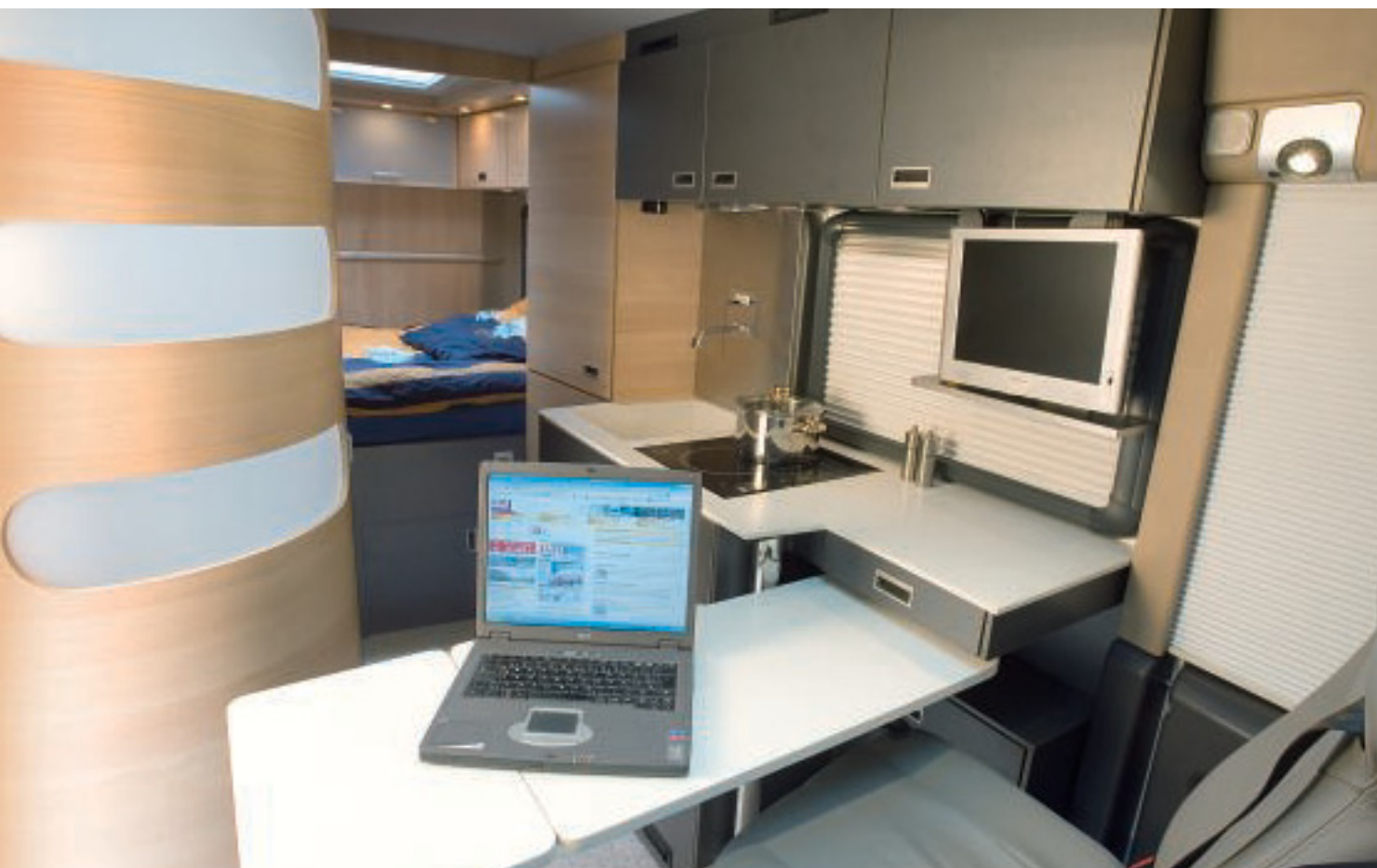
Wird der Tisch nicht gebraucht, lässt er sich zusammenschieben und unter die Arbeitsplatte drehen.
