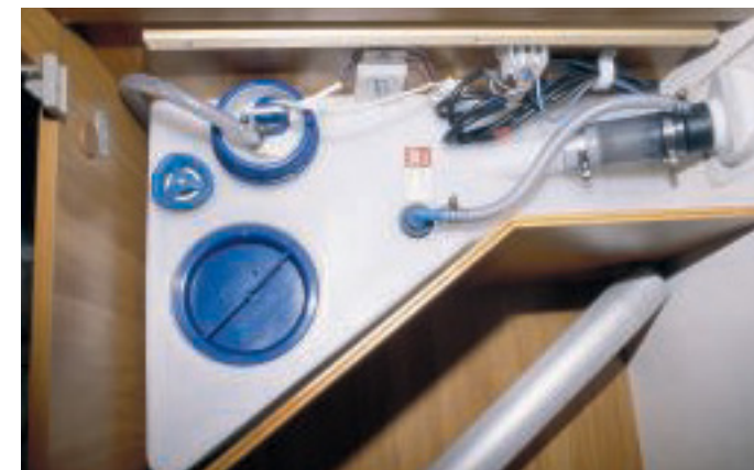
Eingepasst: Auf Maß ist der Frischwassertank samt Tauchpumpe im Kleiderschrank untergebracht.
