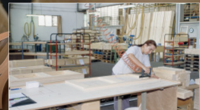
Gerahmt: Stellseiten und Türen entstehen aus Rahmen mit eingelegten Styropor-Einlagen und dünnen Beschichtungen.
