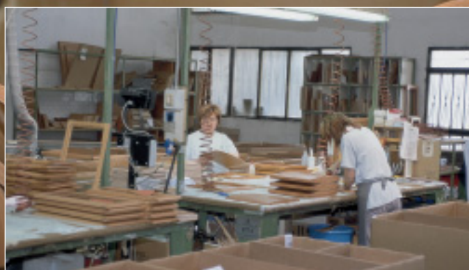
Montiert: In Gruppenarbeit setzen Mitarbeiterinnen im Bologneser Werk die Füllungen in Rahmenklappen.
