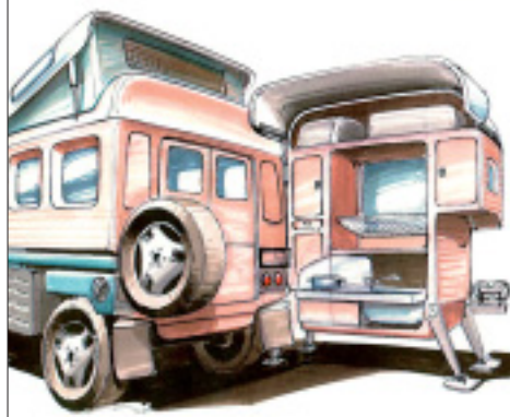
Aufgeklappt: Ein angeschraubtes Funktionsmodul erweitert das Outdoor-Mobil zur Wohneinheit.
