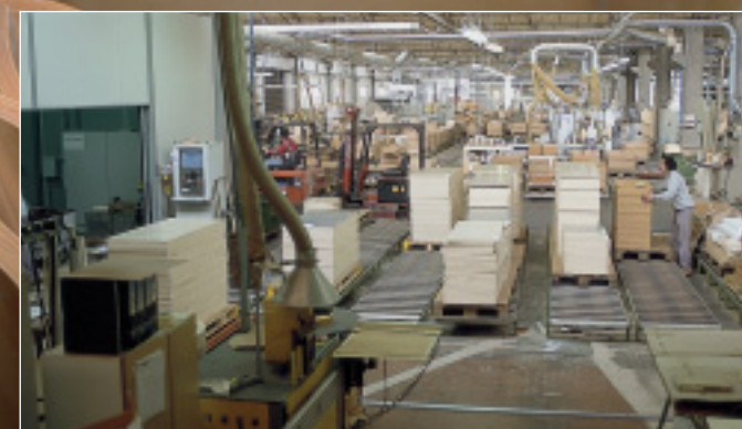
Aufgetürmt: Am Ende der automatischen Fertigungsstraße stapeln sich die zusammengefügte Teile für Verpackung und Versand.
