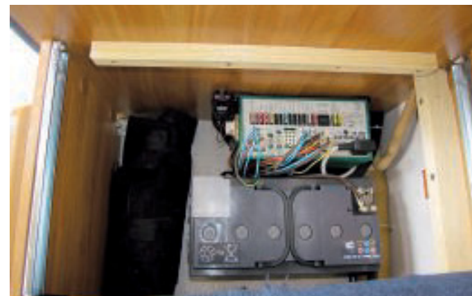
Übersichtlich: Die Elektrik in der linken Sitztruhe sollte besser durch einen Einlegeboden abgedeckt werden.
