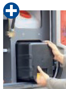
Die Kassette der Unterdrucktoilette ist geruchsdicht.
