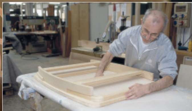
Liebevoll: Vor dem Lackieren prüft ein Schreiner die Passgenauigkeit der Einzelteile eines Tisches für ein Luxus-Segelboot.
