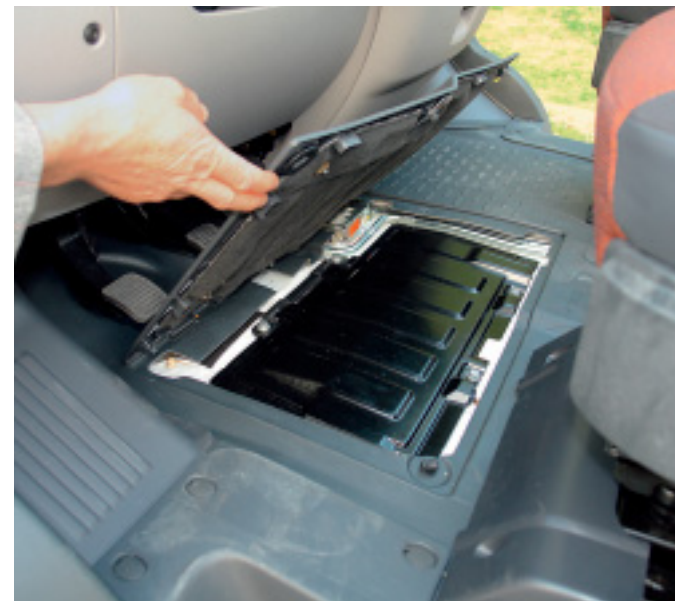
Crashsicher: Starterbatterie im Fahrer-Fußraum.
