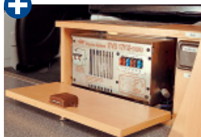
Die Elektrozentrale sitzt leicht erreichbar in einem Extra-Fach.
