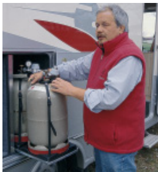
Leicht gemacht: Die Gasflaschen lassen sich zum Tausch ausziehen.
