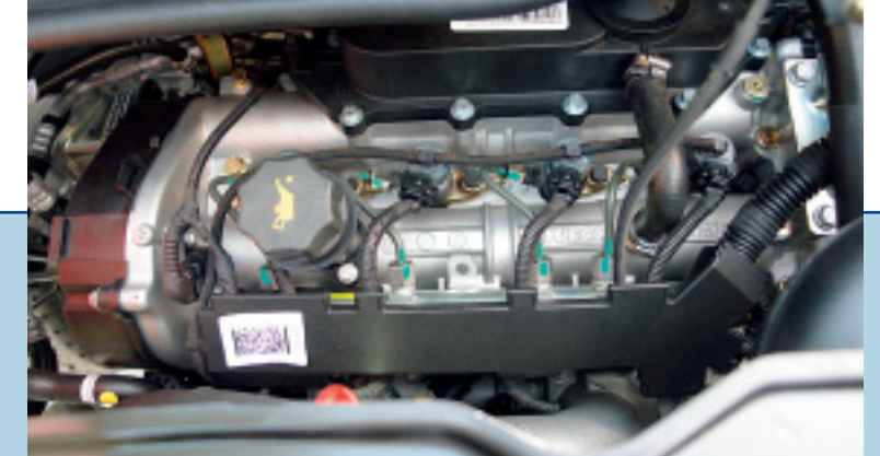
Wartungsfreundlich: Wie bisher quer eingebaut: die neuen, stärkeren Motoren.
