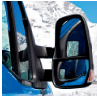
Rücksichtsvoll: ausladende Außen-spiegel mit großflächigem Weitwin-keleinsatz und seitlichen Blinkern.
