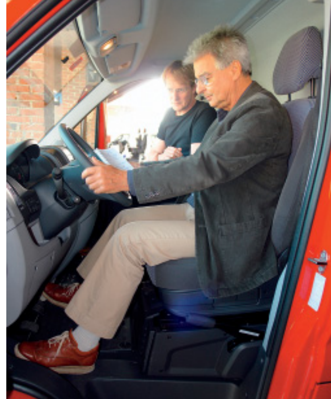
Ergonomisch: Die Lenksäule lässt sich auch in der Länge verstellen.
