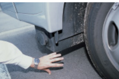
Knapp bemessen: Der Abwassertank hängt sehr tief. Vorsicht an Bordsteinen!
