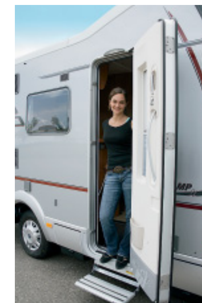
Details: Die Aufbau-tür lässt sich dreifach verriegeln. Eine im Aufbau integrierte Tritt-stufe erleichtert den Einstieg. Neu sind auch die Leuchten-einheiten am Heck.
