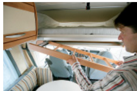
Clever gelöst: Die Einstiegsleiter fürs Bugbett verschwindet in der Unterschale des Bettes.
