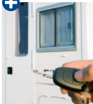
Auch die Aufbautür ist in die Zentralverriegelung eingebunden.
