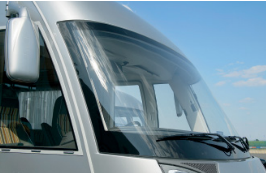
Zur neuen Optik trägt die als Einheit in der Frontpartie verklebte Windschutzscheibe bei.
