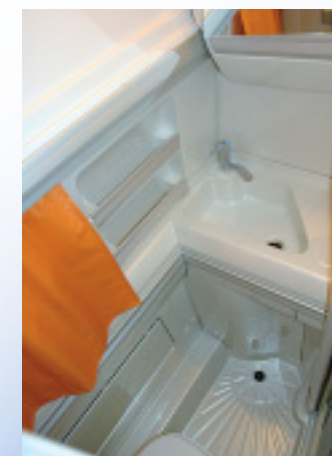
Das kompakte Bad besteht aus gut eingepassten Kunststoffformteilen.
