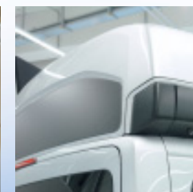
Die Markise ist elegant in das Kunststoffdach integriert.
