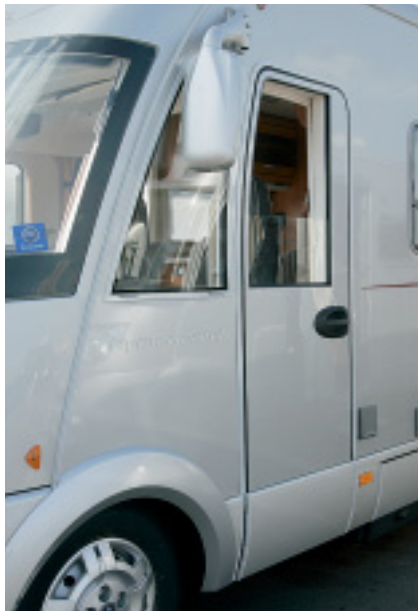
Die Fahrerhaustür hat eine Zweifachsicherung und einen zehn Zentimeter breiteren Einstieg.
