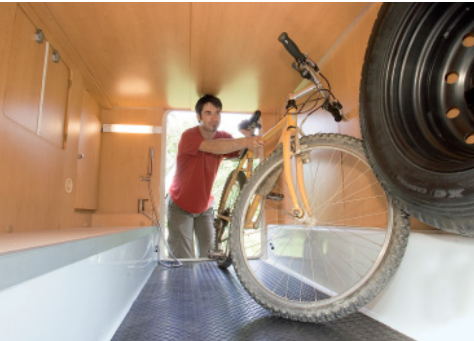
Der Boden der geräumigen Heckgarage besteht aus einer GFK-Wanne und lässt sich leicht reinigen. Das Reserverad ist vorbildlich montiert.
