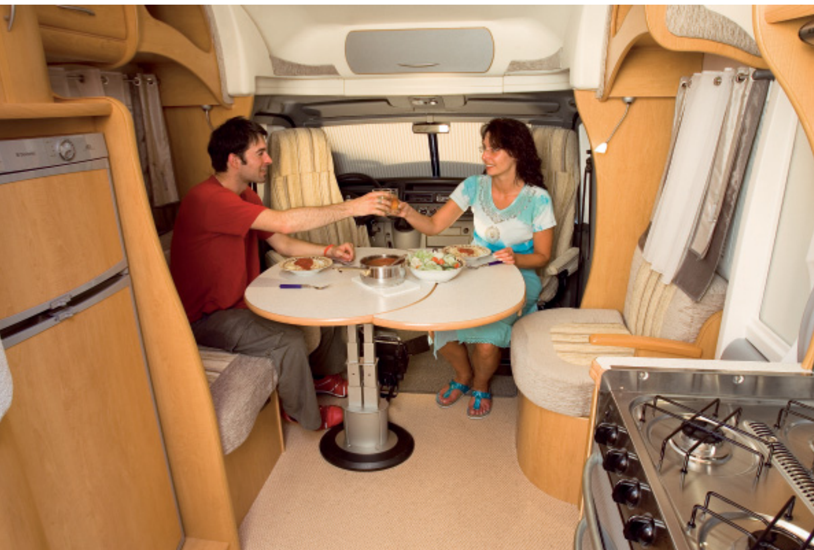
Die Tischplatte lässt sich durch ein gut funktionierendes Ausziehsystem erweitern. Kein Problem ist auch, den Tisch abzusenken, um einen weiteren Schlafplatz zu bauen.
