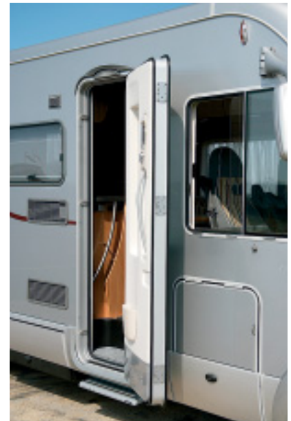
20 Millimeter breiter wird die dreifach verriegelte Aufbau-tür mit pfiffigem Türfeststeller.
