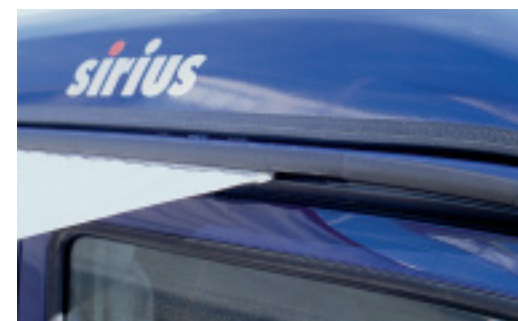
Die Regenrinne Multi Rail von Reimo hält Sonnensegel, Vorzelte oder Dachträger.
