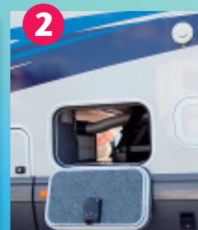
2 Der durchgehende Doppelboden mit 42 cm Höhe lässt sich von außen und innen (mittels Bilgenklappen) beladen.
