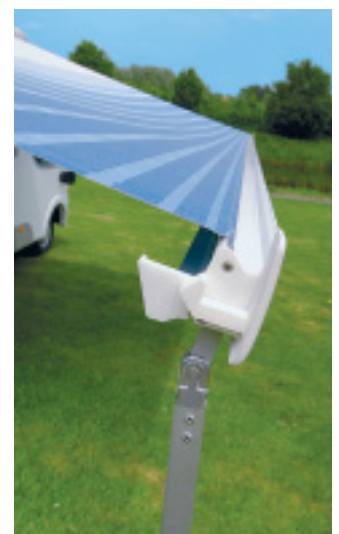
Beim Einfahren verschwinden die Stützen im Frontprofil.
