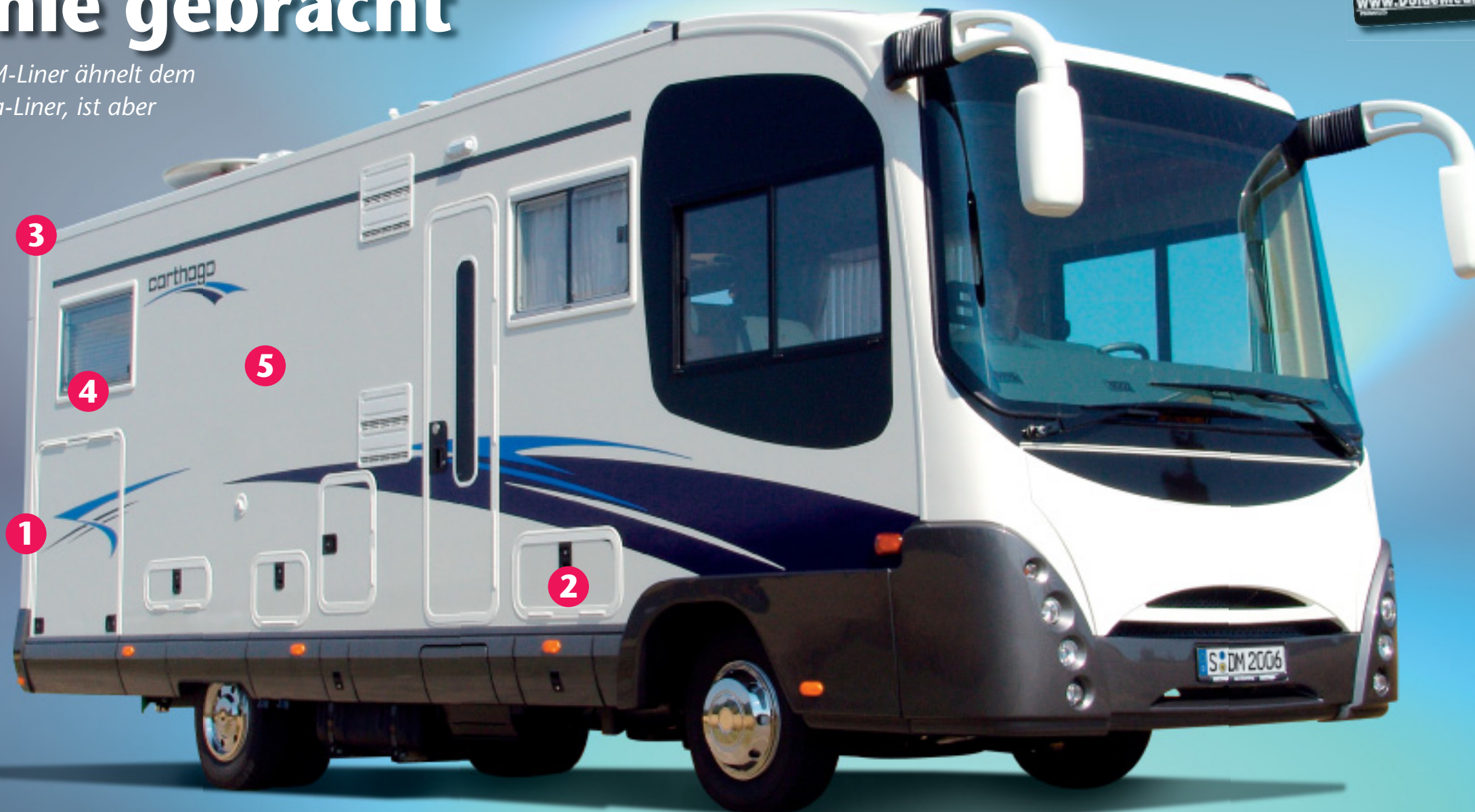
3 Mit dem aufgesetzten Heckrahmen wirkt der M-Liner dynamischer als bisher. Die sechs Teile des Rahmens lassen sich einzeln austauschen.
