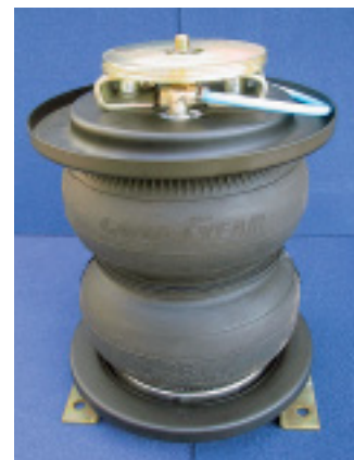
Per Zusatzluftfeder will Kuhn die Fahreigenschaften von Sprinter und Crafter verbessern.
