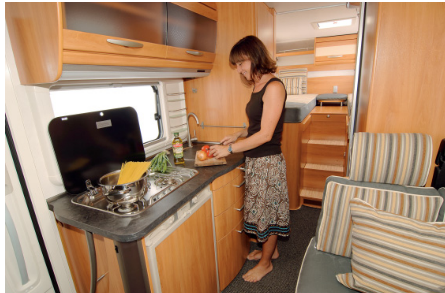
Die Schubladen unter der Spüle laufen ausgezeichnet. Die unterste nimmt zwei Mülleimer auf. Eine Zentralverriegelung sichert sie während der Fahrt.
