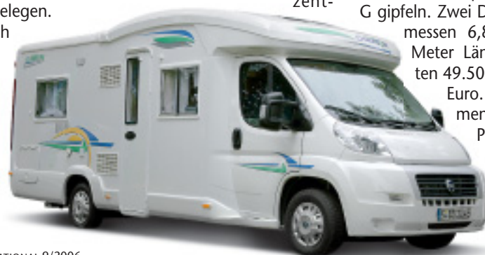
Der Chausson Allegro hat ein komplettes GfK-Dach. Die beiden Dachelemente stoßen etwa in der Mitte zusammen.
