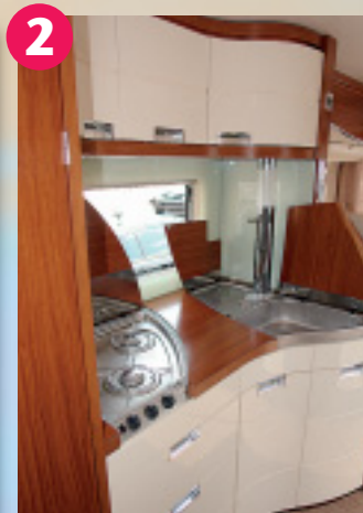
Der Dreiflamm-Kocher mit vorne abgesetzten Bedienelementen ist eine Spezialentwicklung.
