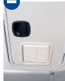
Ungünstig angebrachte Gas-Entlüftung.
