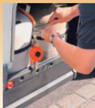
Im Abstand von zwei Jahren muss ein Fachmann die Dichtheit der Gasanlage prüfen, um altersbedingte Schäden zu erkennen.
