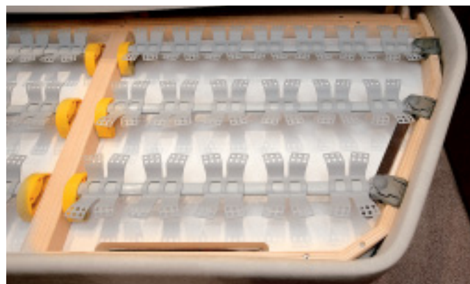
Untertellergröße Federauflagen in verschiedenen Härtegraden beim Froli Star Mobil System (links). Carawinx-Flügelfedern wie beim Concorde Liner von Thomas sitzen auf elastischen GfK-Rohren.
