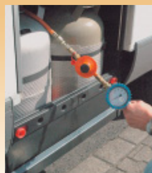
Im Abstand von zwei Jahren muss ein Fachmann die Dichtheit der Gasanlage prüfen, um altersbedingte Schäden zu erkennen.
