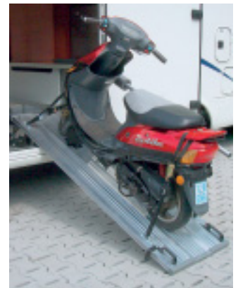
Der Heckgaragenauszug von Linnepe schont dank Gasdruckfedern das Kreuz.
