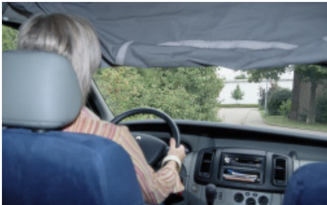
Vorsicht: Ist der Zeltstoff nicht sauber eingelegt, kann er bei hohen Geschwindigkeiten ins Fahrerhaus gedrückt werden.
