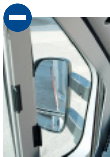
Der Rahmen der Verdunklung verdeckt den Außenspiegel.
