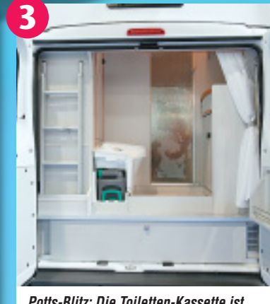
Potts-Blitz: Die Toiletten-Kassette ist ganz einfach über die Hecktür zu erreichen. Unten das ausziehbare Staufach.
