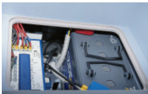
Dauereinsatz: Auch das Doldemedien-Fernsehteam nutzte den Adria gerne. Das Panel ist übersichtlich und lässt sich einfach bedienen, Batterie und Ladegerät sind in einem separaten Fach untergebracht.
