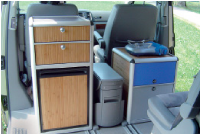
Mit den Möbelmodulen von Movarimo ist der Umbau einer Großraumlimousine in ein Reisemobil in kurzer Zeit erledigt.
