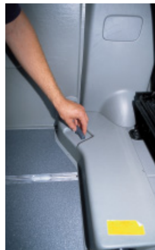
Prima Idee: Der Ablasshahn für den Abwassertank sitzt hinter dem Fahrersitz im Inneren des X-Cursion H.
