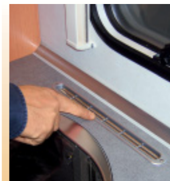
Eine Wasserheizung mit Konvektoren setzt einen angepassten Möbelbau mit großzügigen Hinterlüftungen voraus.
