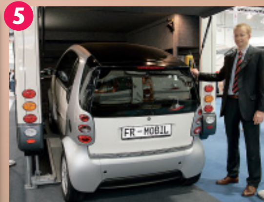
Einfahrhilfe: Der Boden der Heckgarage lässt sich absenken. Das vereinfacht die Unterbringung des Begleitfahrzeugs.
