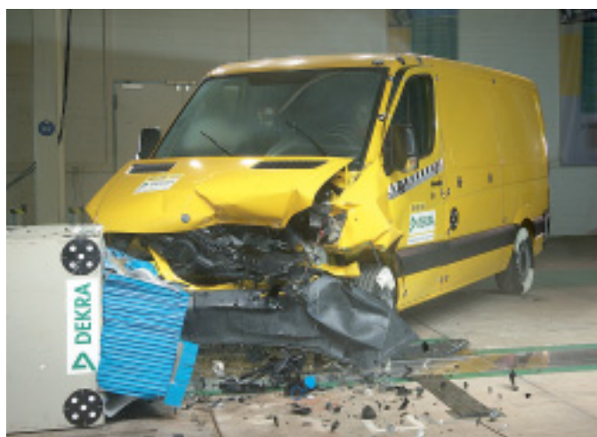
Durch die 40-prozentige Überdeckung dreht sich der Sprinter aus der Bahn. Die Tür ließ sich völlig problemlos öffnen.
