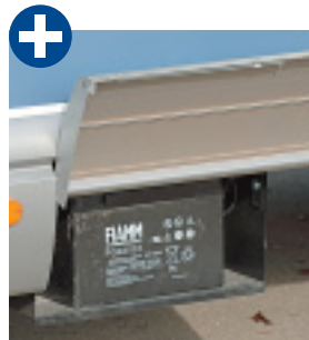
Extra-Wurst: Die Bordbatterie sitzt leicht erreichbar in einem Unterflur-Servicefach.
