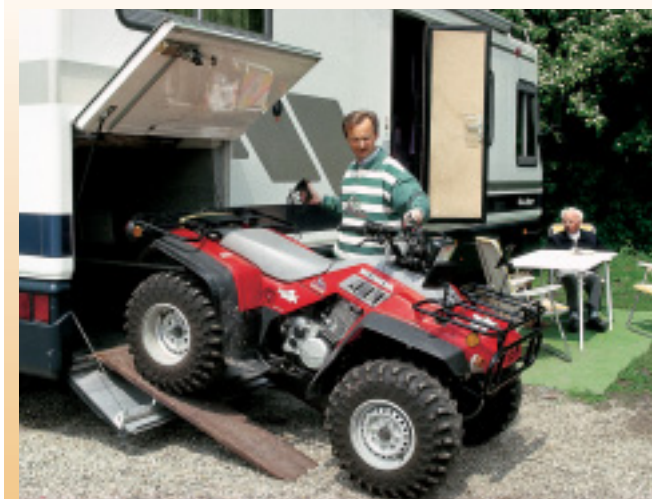
Vorsicht: Ein Quad in der Heckgarage belastet die Hinterachse deutlich mehr, als sein Eigengewicht. Die Vorderachse wird dadurch entlastet.
