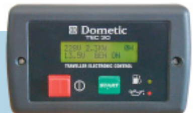
Die fest ins Mobil eingebauten Generatoren lassen sich über Fernbedienungen komfortabel steuern und kontrollieren.
