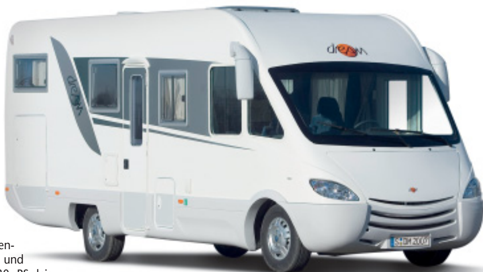
Aus einem Guss: die Monocoque-Kabine des X-Dream 500 g.
