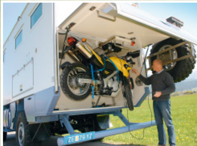
Die Klappe der Heckgarage schwingt, unterstützt durch Gasdruckfedern, nach oben und gibt den elektrischen Flaschenzug frei, der sogar Motorräder schafft.
