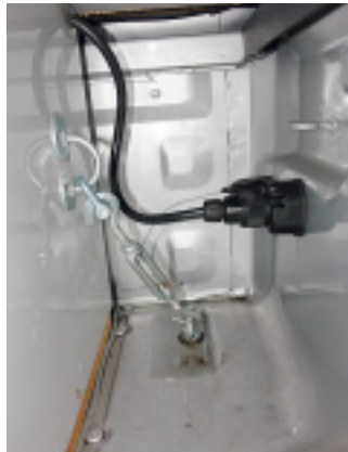
Vier Spannschlösser (351 Euro) sichern die Kabine auf der Pritsche.
