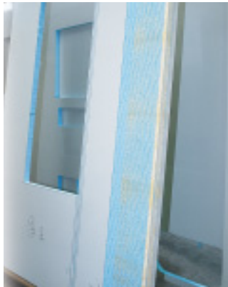
Styrofoam ist dank seiner blauen Farbe leicht von Styropor oder Polyurethan zu unterscheiden.
