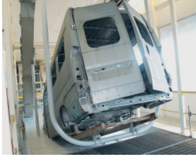
Gut vorbereitet: Bis der Fiat Ducato in die Kataphorese, ein elektro-chemischer Korrosionsschutz, abtaucht, hat er einige Stationen der Karosseriefertigung hinter sich. Insgesamt dauert es 30 Stunden, bis an dem Kleinlaster alles montiert ist.
