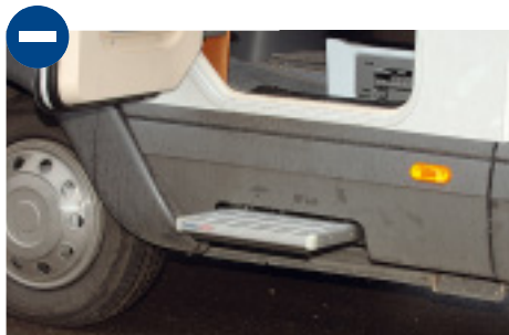
Die elektrisch ausfahrbare Einstiegstufe liegt 49 Zentimeter hoch und ist alles andere als bequem.
