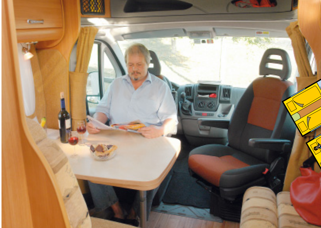
Fahrer- und Beifahrersitz lassen sich mühelos zur Halbdinette drehen. Der abgesenkte Tisch ist Grundlage für das Gästebett.
