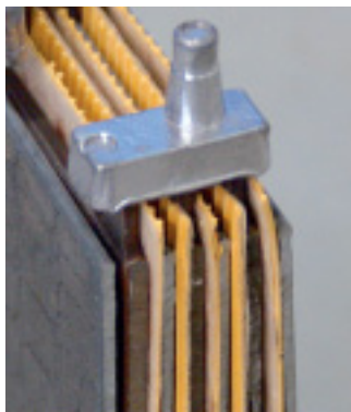
In der Batteriezelle trennen Separatoren positive und negative Platten.
