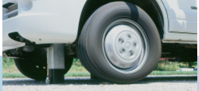
Ein Mobil zu nivellieren erfordert vorn und hinten angebrachte Hubstützen.
