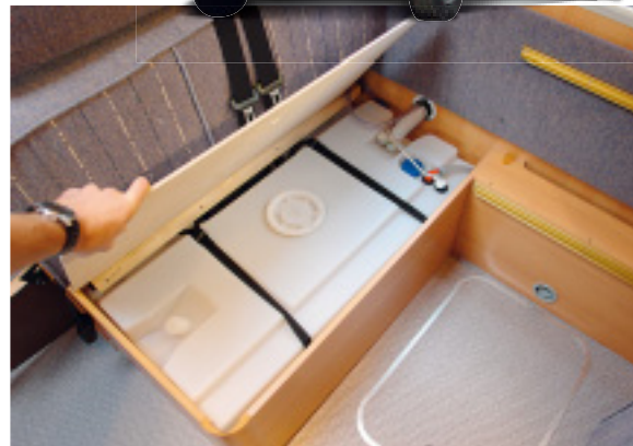
Vertrauenssache: Zwei dünne Nylonbänder sollen den 85-Liter-Frischwassertank fixieren, der lose in der Sitztruhe lagert.
