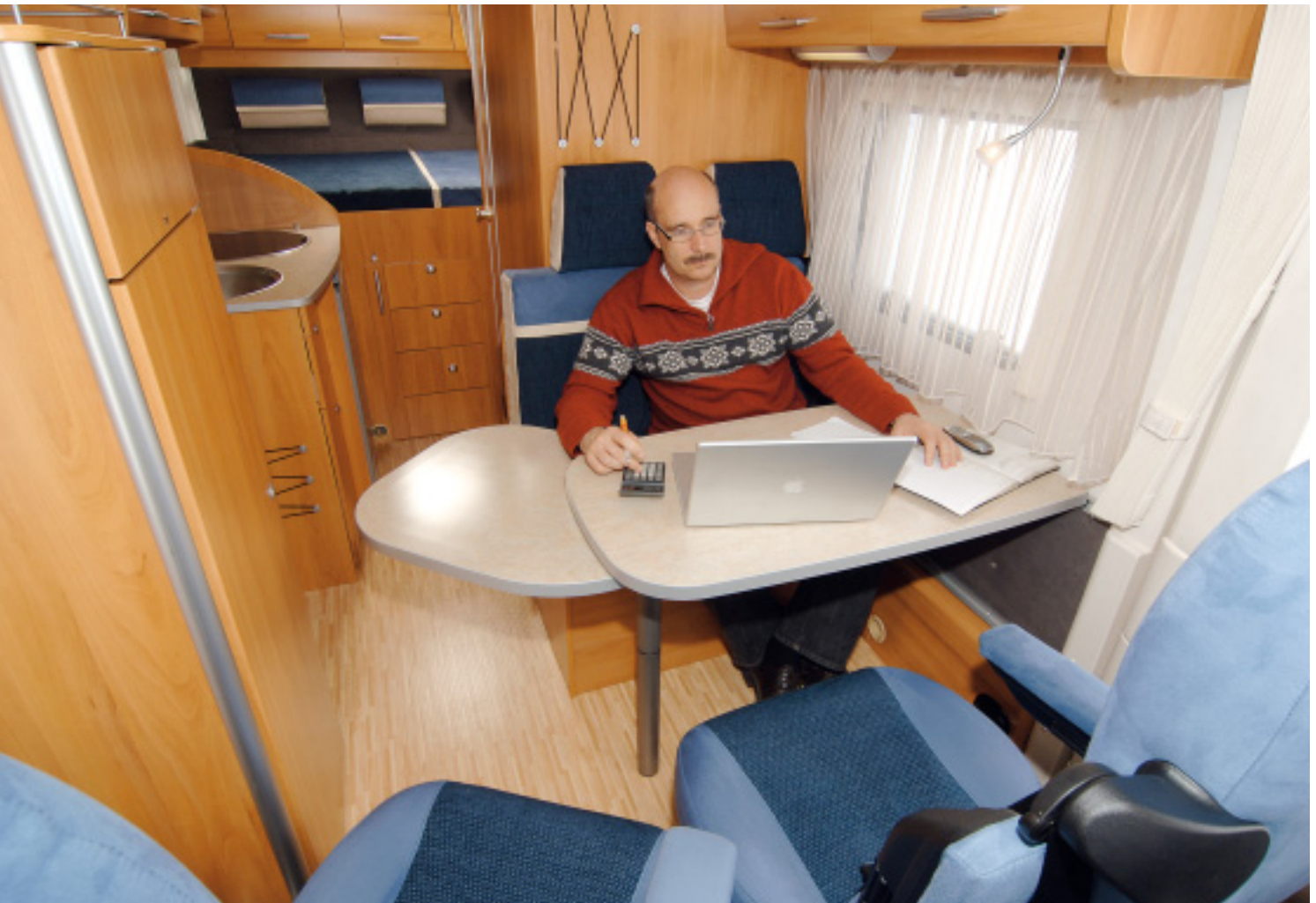
Die Tischplatte misst 96 mal 55 Zentimeter. Die herausdrehbare Platte erweitert ihn um 40 Zentimeter. Sie ist von dem gedrehten Beifahrersitz gut zu erreichen.
