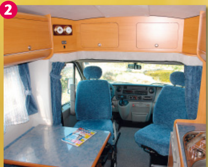
Die drehbaren Frontsitze sind mit Polsterstoff überzogen. Das Dach ist innen mit Schaumstoff hinterlegt und mit weichem Kunstleder verkleidet.
