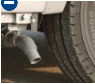
Der Ablassstutzen direkt hinter dem Rad ist ständig Schmutz ausgesetzt.
