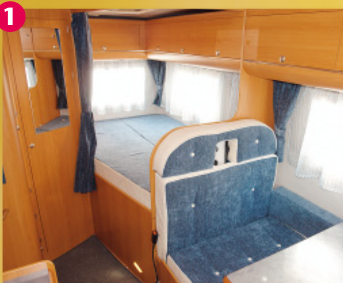
Die Möbel machen einen soliden Eindruck, nichts knarzt beim Fahren. Aus der Halbdinette, dem Tisch und dem Fahrersitz entsteht ein zweites Bett.
