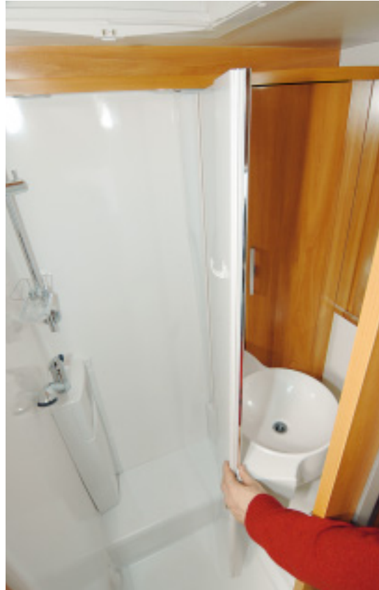
Das bekannte Hymer-Vario-Bad. Die hintere Kunststoffwand lässt sich samt Waschbecken wegklappen. Sie bildet dann die Duschabtrennung zum WC. Rechts im Eck der gut unterteilte Schrank. Hier befindet sich auch die 230-V-Steckdose.
