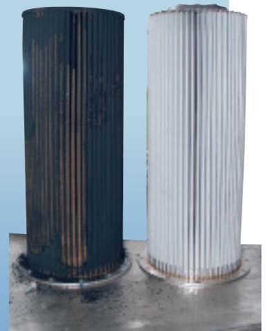
Nachher – vorher: Der DES-Filter hält mehr als 99 Prozent des Rußes aus dem Abgas zurück.
