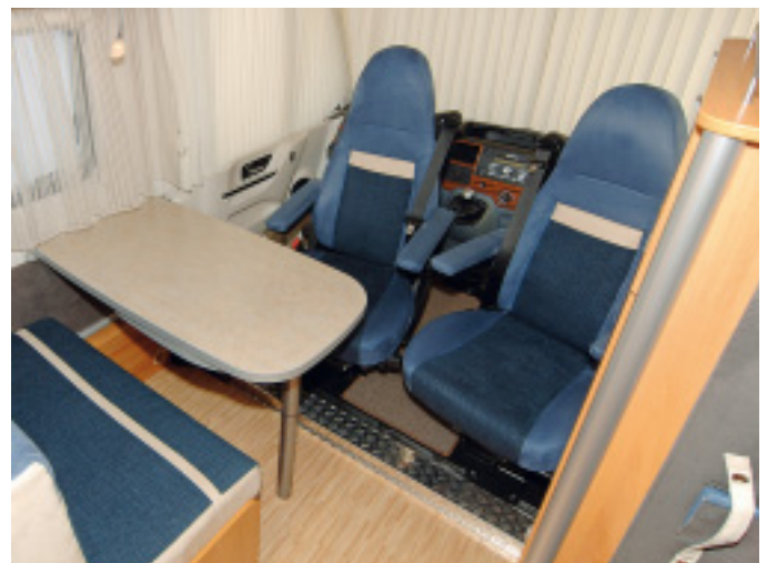
Die Tischplatte misst 96 mal 55 Zentimeter. Die herausdrehbare Platte erweitert ihn um 40 Zentimeter. Sie ist von dem gedrehten Beifahrersitz gut zu erreichen.
