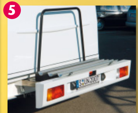
Ein Schmuckstück: Die Stoßstange muss herausgezogen und der Träger aufgeklippt werden.
