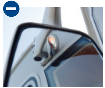
- Die Positionslampe beleuchtet den Arm des Spiegels sowie Schmutz und Tropfen.
