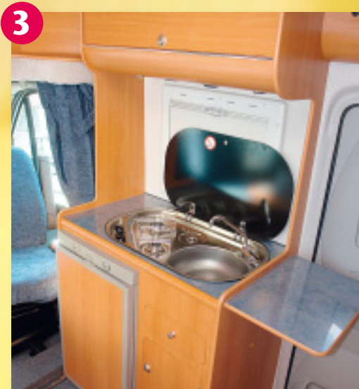
Die Küche fällt kompakt aus, hat aber eine elektrische Zündung und ein zusätzliches Resteaussgussbecken.
