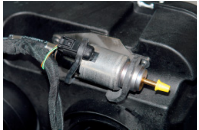
Die Dosierpumpe findet bei Webasto ihren Platz am Gerät oder in der Zuleitung.
