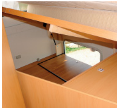
Beidseitig offen: Der Stauraum im Heck lässt sich über das hochgeklappte Bett und die Außenklappe beladen.
