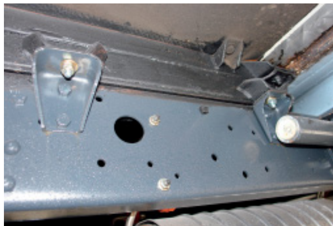
Die Verbindung von Chassis und Aufbau erfolgt durch Brückwinkeln.
