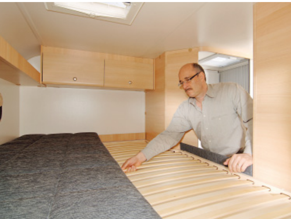
Das quer im Heck eingebaute Doppelbett verjüngt sich am Fußende. Die Latten des Rostes sind stabil in einem massiven Rahmen verankert.
