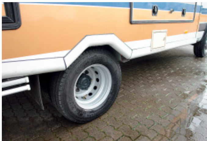
Den Radkasten hat Wolfgang Riepert an den veränderten Radstand angepasst.
