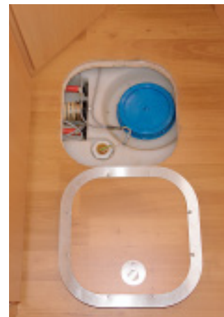
Optimal platziert: der 100-Liter-Frischwassertank im Zwischenboden.
