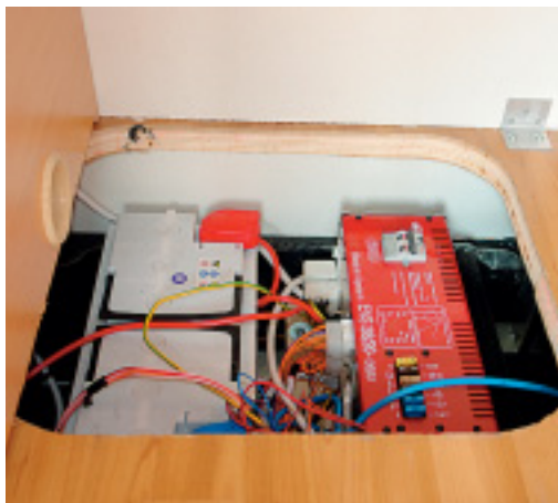
Praktisch: Die aufgeräumte Elektrozentrale steht im Zwischenboden und ist über eine Klappe leicht zu erreichen.
