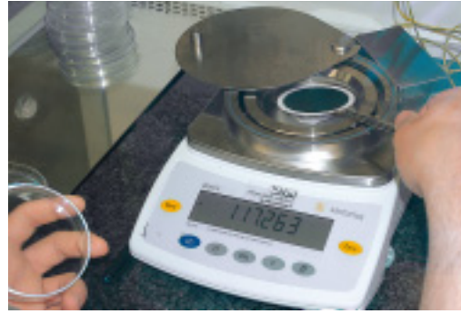
Exakt: Eine äußerst genaue Waage bestimmt die Masse der Rußpartikel. Das Filterpapier ist normalerweise weiß.
