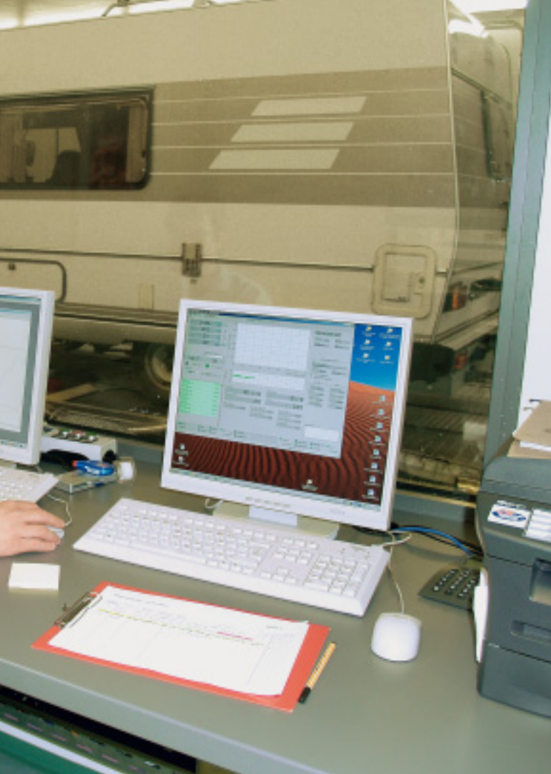
Richtig Gas geben: Der Monitor diktiert dem Fahrer die richtigen Schaltpunkte.
