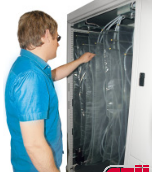
High-Tech pur: Das Prüfzentrum hat sich auf Abgasmessungen spezialisiert. Große Säcke fangen die Gase auf und analysieren sie nach ihrer Menge und Zugehörigkeit.
